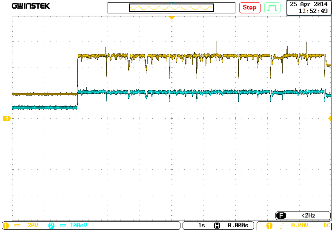
Şekil 5.7. Deęiştir gözle algoritması, adımlar arası süre 1 ms için çıkış
