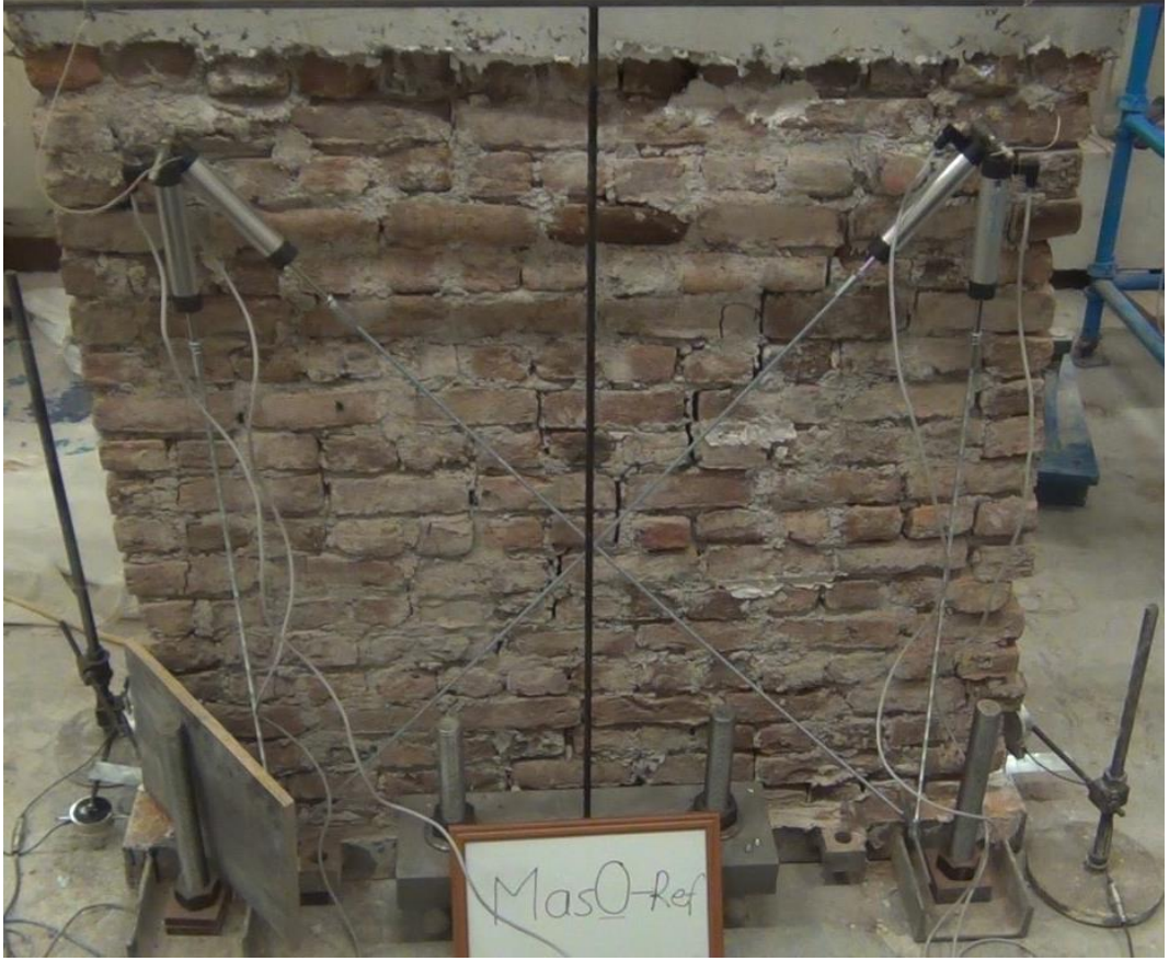
Şekil 3.31. Mas0 - Ref. numunesi çatlama şekilleri
