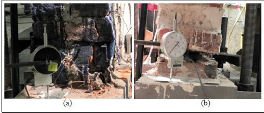
Şekil 3.47. Mas1 - CFRP. numunesi basınç (a) ve çekme bölgesinde (b) oluşan çatlaklar
