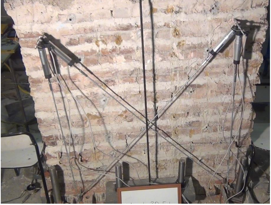
Şekil 3.41. Mas1 - 3D Fab. numunesi çatlama şekilleri
