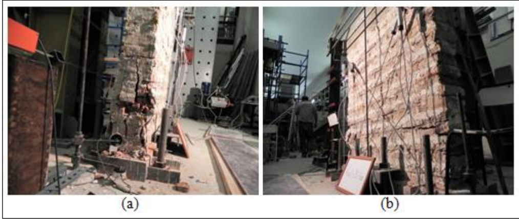
Şekil 3.42. Mas1 - 3D Fab. numunesi basınç (a) ve çekme bölgesinde (b) oluşan çatlaklar
