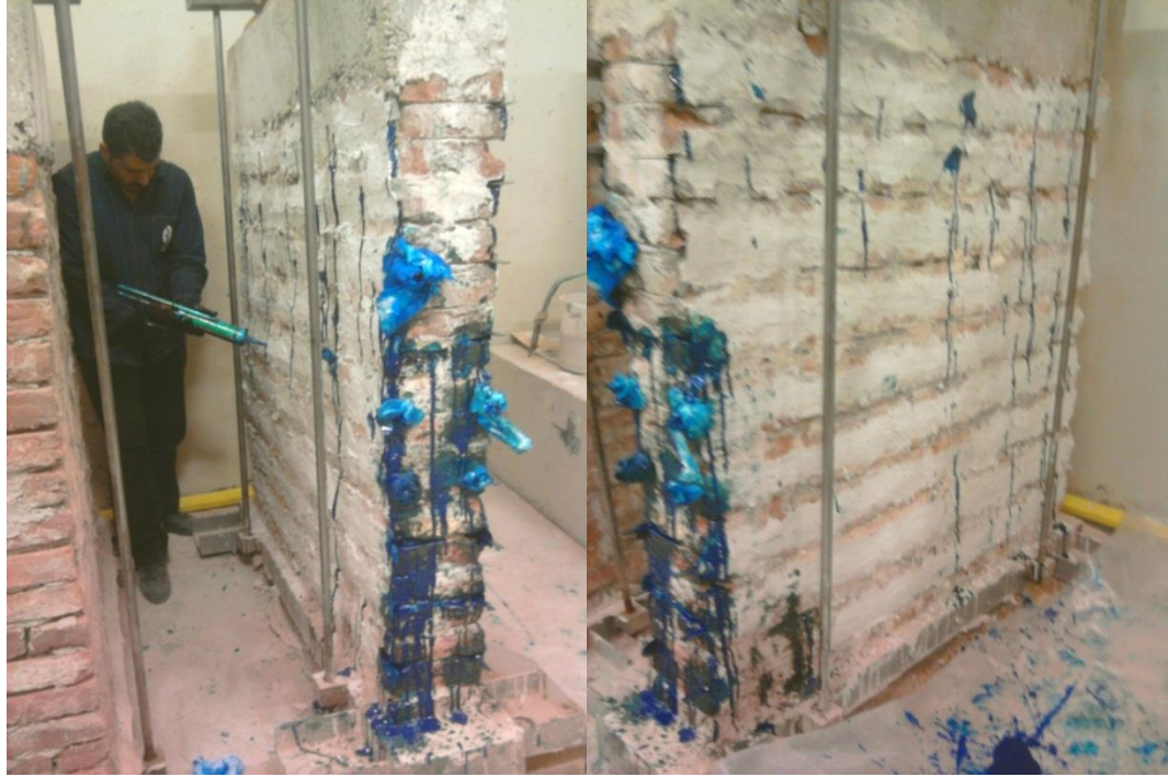
Şekil 3.22. CFRP plaka ve epoksi ile güçlendirme işlemi
