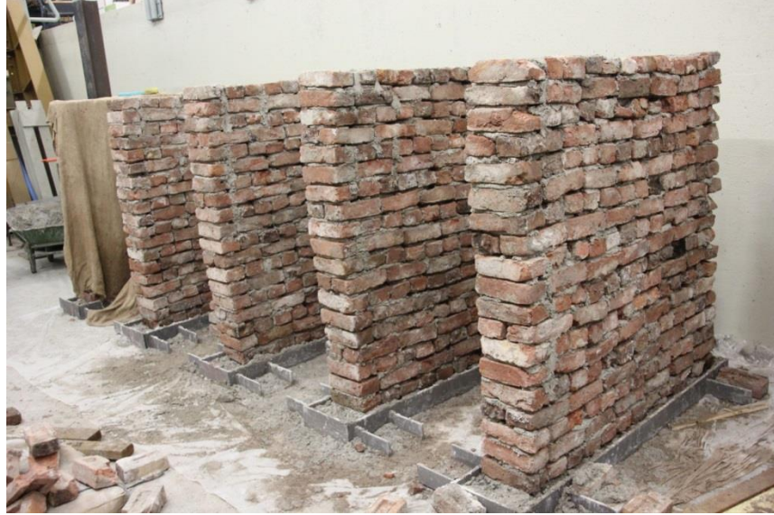
Şekil 3.16. İmalatı yapılmış 5 adet tuğla duvar numunesi
