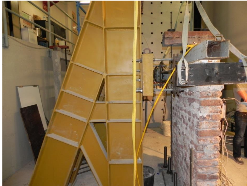
Şekil 3.24. Düzlem dışı hareketi önleme düzeneği
