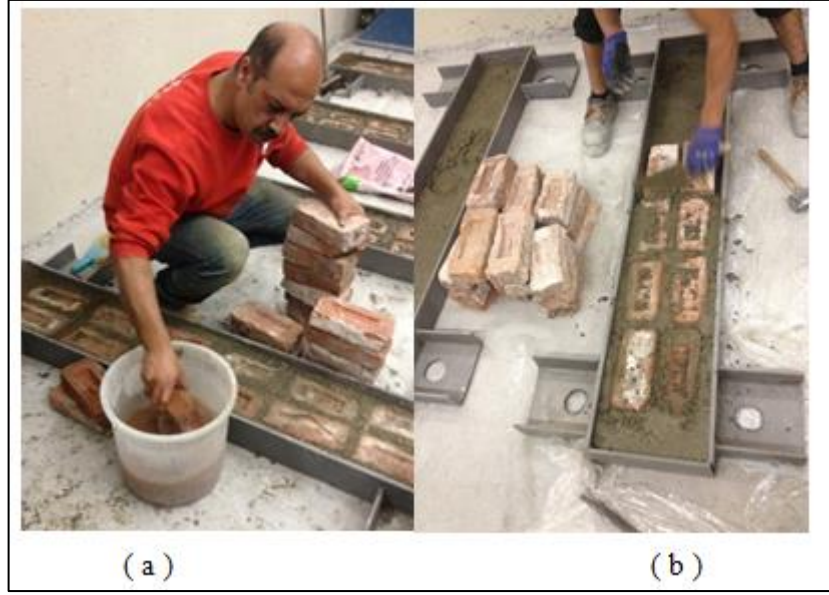
Şekil 3.12. a) Tuğlaların ıslatılması işlemi, b) Temel imalatı
