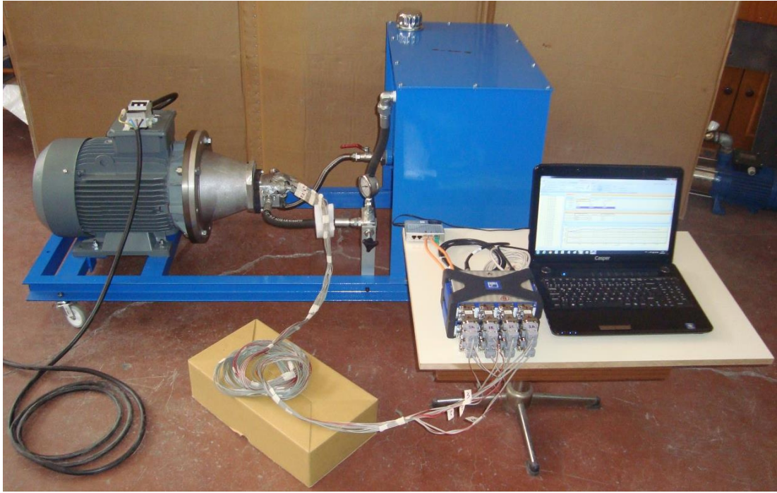
Şekil 2.9. Eş değer gerilme değerlerini ölçmek için kurulan deney düzeneği
