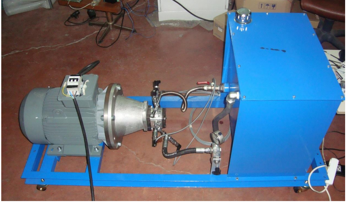
Şekil 2.4. Basınç dağılımını ölçmek için kurulan deney düzeneği
