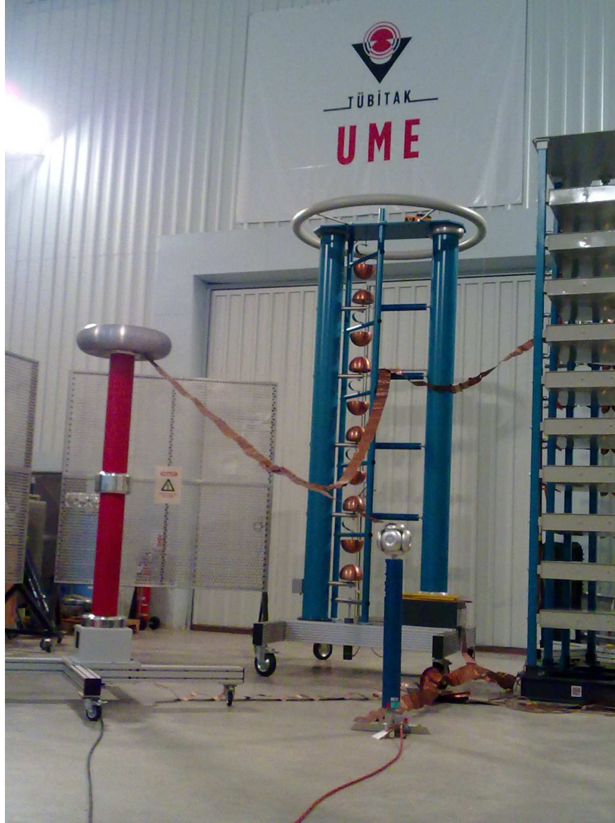
Şekil 7.1: Bölüm Oranı Belirlenmesi için Kurulan Deney Düzeneği
