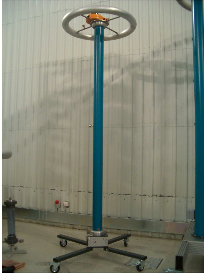
Şekil 2.11: 1000 kV'luk Karma (Sönümlü) Tip Kapasitif Gerilim Bölücü
