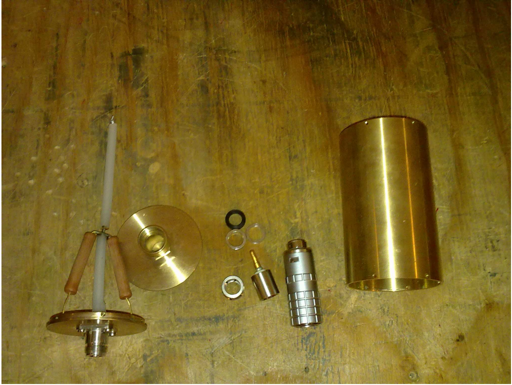
Şekil 6.11: Referans Gerilim Bölücüsünün Alçak Gerilim Kolu Elemanları
