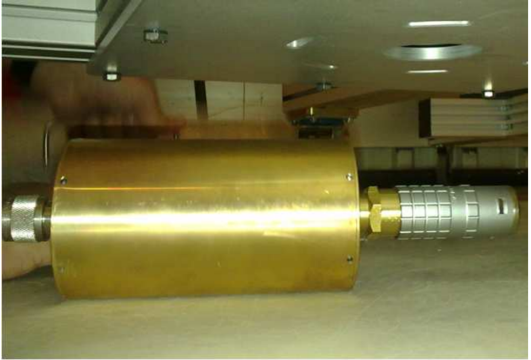
Şekil 6.13: Referans Gerilim Bölücüsünün Alçak Gerilim Kutusu
