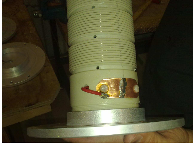
Şekil 6.4: Polipropilen Boruya Sarılan Direnç Teli ve Kontak Noktasının Görünümü
