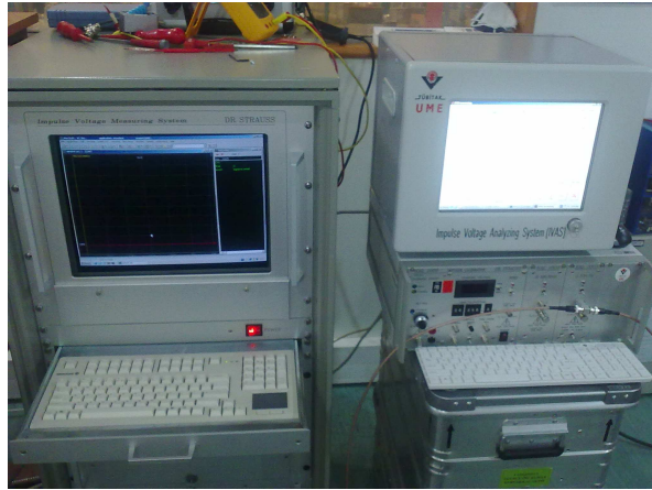
Şekil 7.2: Anahtarlama Darbe Gerilim Ölçümü Deney Düzeneği
