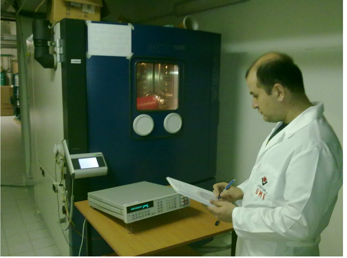
Şekil 7.4: Referans Gerilim Bölücüsünün Sıcaklık Etkisi Deneyi
