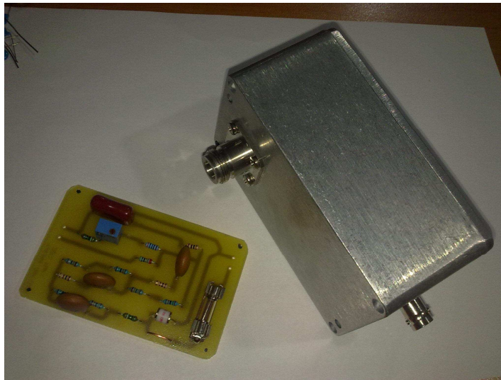
Şekil 4.14: Devre Kartı ve İçine Koyulacağı Alüminyum Kutunun Görünümü
