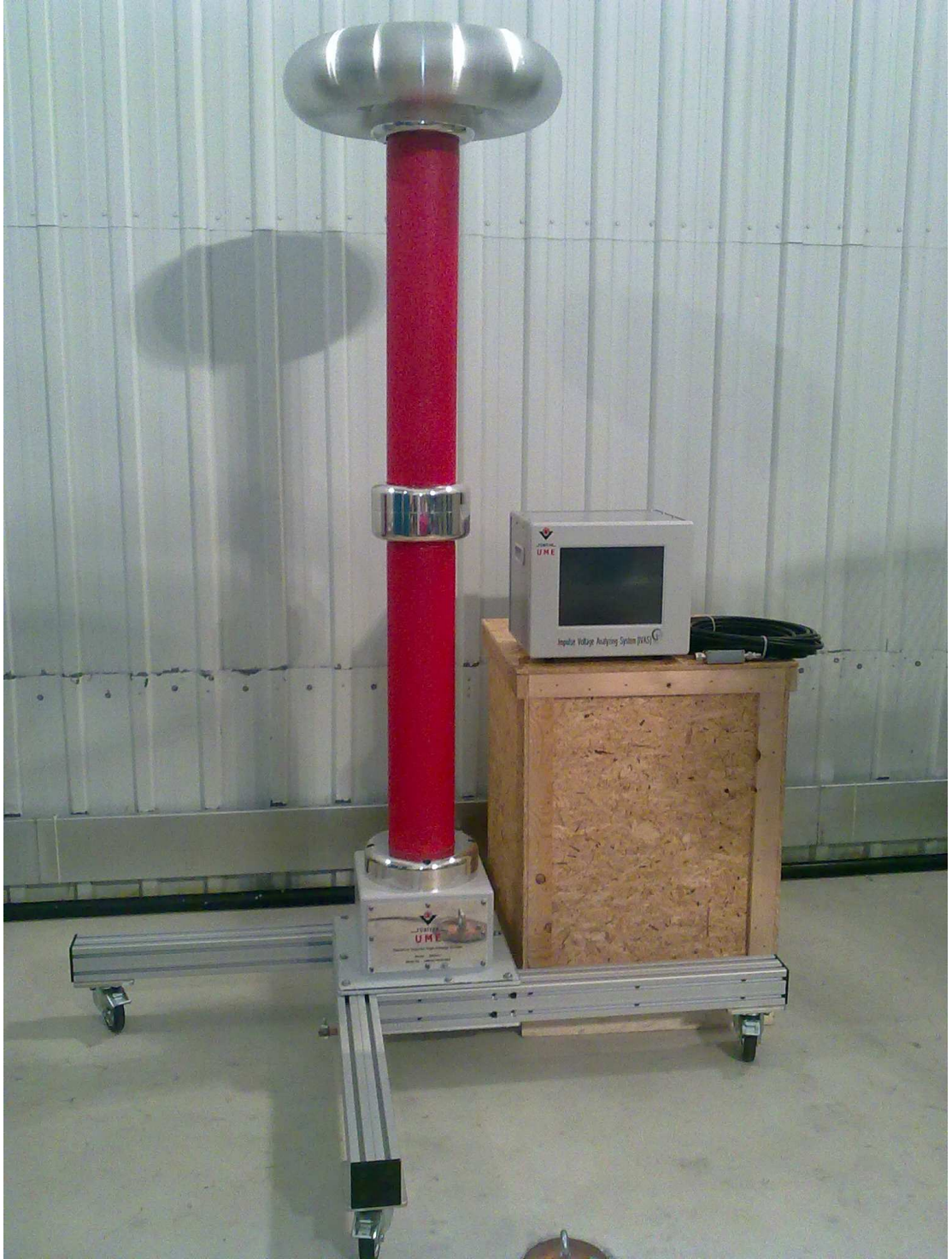
Şekil 6.21: Referans Gerilim Bölücüsü, Darbe Kayıt Cihazı ve Ölçüm Kablosundan Oluşan Darbe Yüksek Gerilim Ölçüm Sisteminin Görünümü
