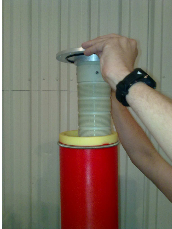
Şekil 6.5: Direnç Modülünün Kestamit Boru İçine Yerleştirilmesi
