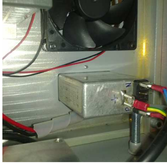
Şekil 5.7: Sigortalı ve Harmonik Filtreli Besleme Modülü
