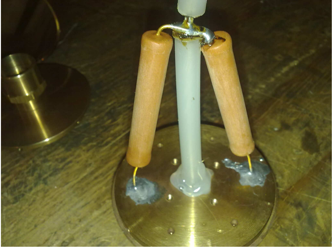
Şekil 6.12: Referans Gerilim Bölücüsünün Alçak Gerilim Dirençleri
