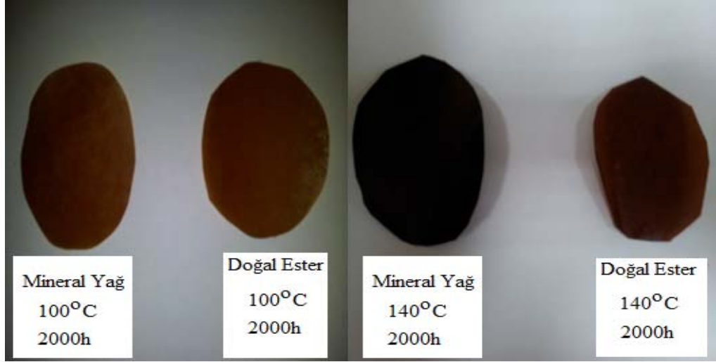
Şekil 5.10. 2000 saat süresince 100°C ve 140°C’de yaşlanmış kâğıt numuneler
