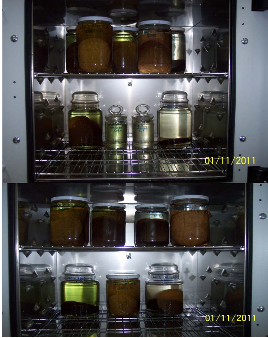
Şekil 5.6. Kâğıt numunelerin ısıl yaşlanma amaçlı hazırlanması
