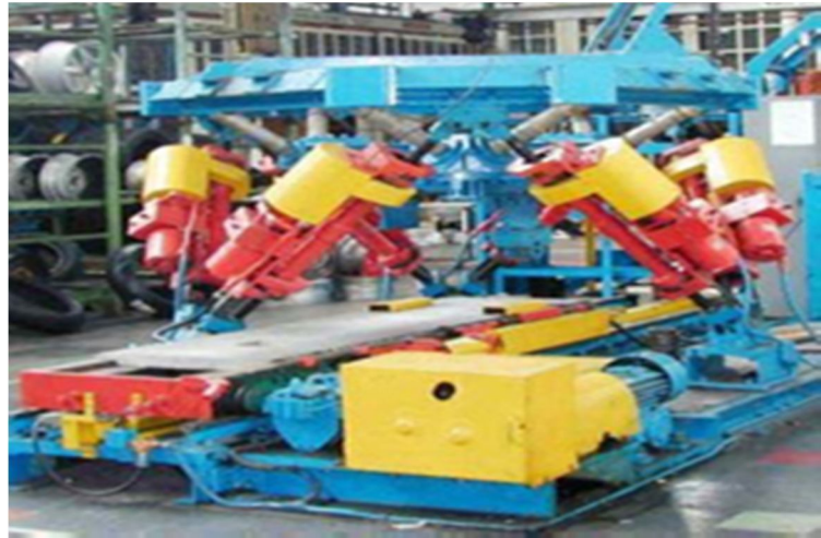
Şekil 1.3. Geliştirilmiş Gough Platform lastik test makinesi
