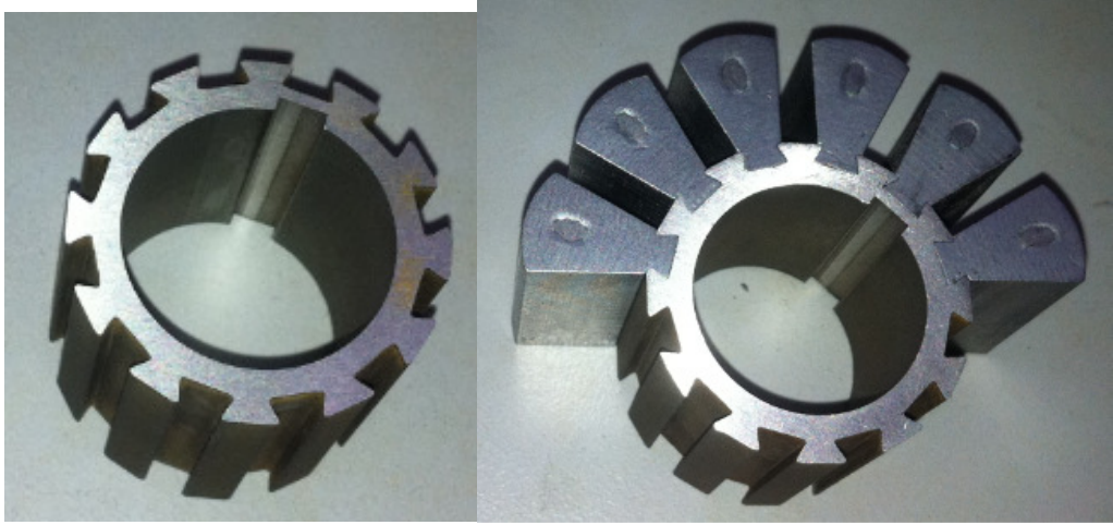
Şekil 6.4. Rotor adaptörü ve segmentlerin adaptöre yerleştirme aşaması
