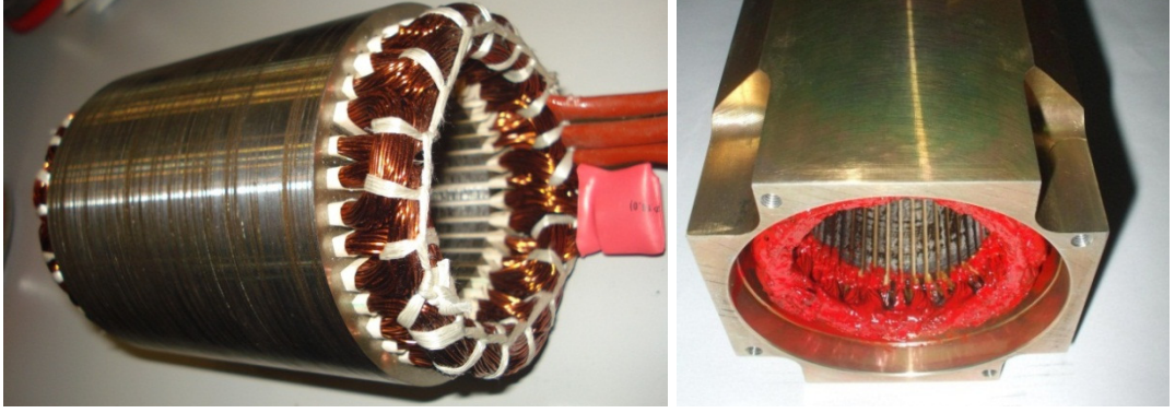
Şekil 3.2. Tasarlanacak DM motor stator yapısı ve bitmiş gövde resmi
