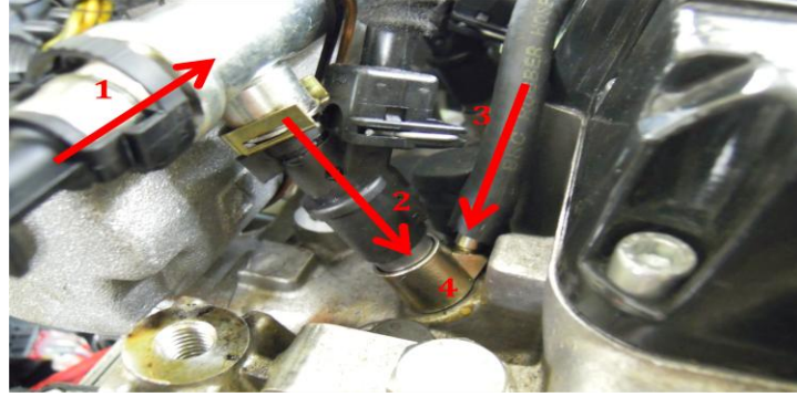
1) Orijinal yakıt hattı; 2) Benzin enjektörleri; 3) Gaz besleme hortumu; 4) Üç yollu pipo.
