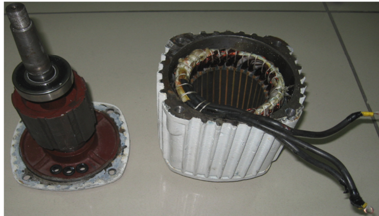
Şekil 5.3. Kullanılan DMSG'nin rotor ve stator resmi
