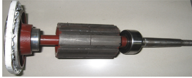
Şekil 5.2. Kullanılan DMSG'nin rotor resmi
