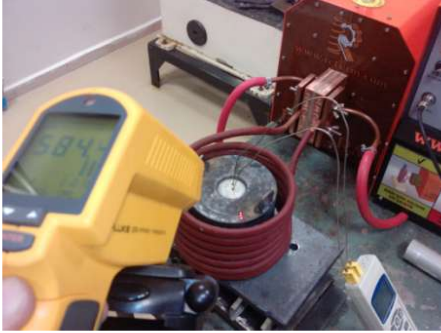
Şekil 4.27. Birinci seri yarı-katı ekstrüzyon denemeleri için numunelerin ön ısıtma işlemi
