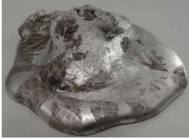
Şekil 4.36 İkinci seri yarı-katı ekstrüzyon denemelerinde makroyapı görüntüsü
