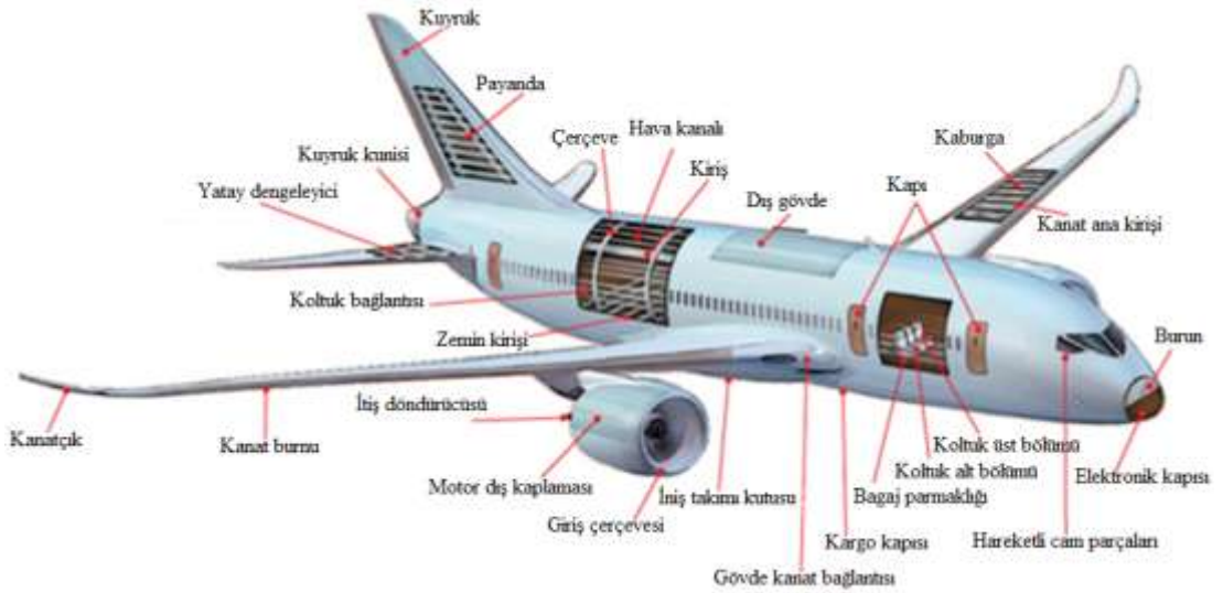
Şekil 1.3. Alüminyumun uçak gövdesinde kullanımı [2]
