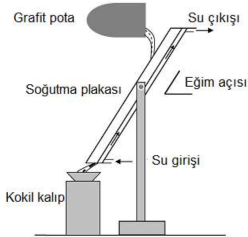
Şekil 1.10. Soğutma plakası (cooling slope) şematik gösterimi [19]
