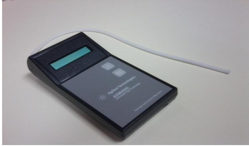
Şekil 3.10. Agilent Flowmeter ADM 2000 model gaz akış ölçer
