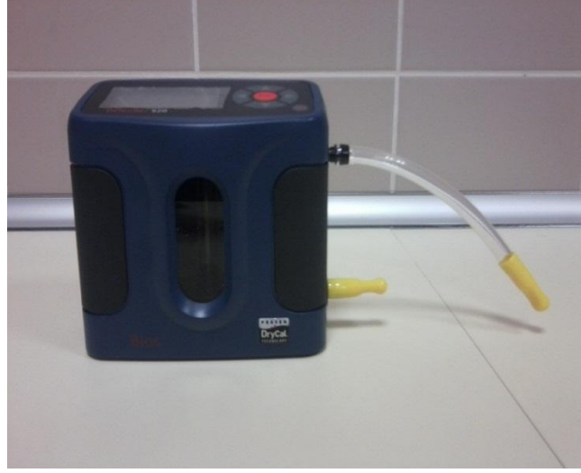
Şekil 3.3. Çalışmada kullanılan PROVEN DryCal Technology Defender 520 model kalibrasyon aleti
