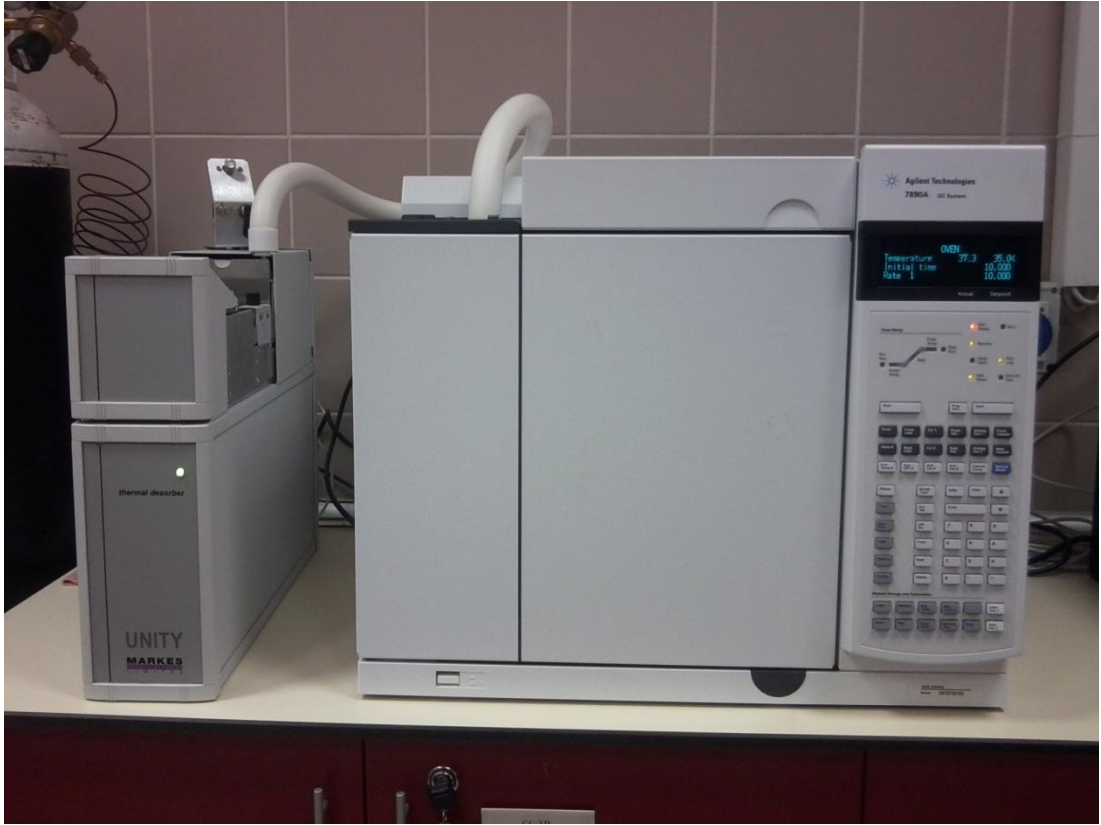
Şekil 3.8. Çalışmada kullanılan thermal desorber ve GC-FID cihazı
