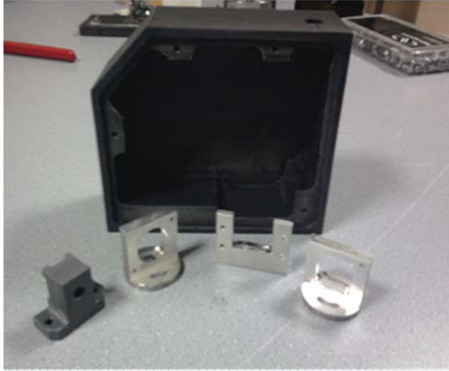
Şekil 2.5. Sistemin mekanik aksamın oluşturulmasında kullanılan parçalar; yarık, ayna, CCD, ızgara tutacağı ve ana gövde
