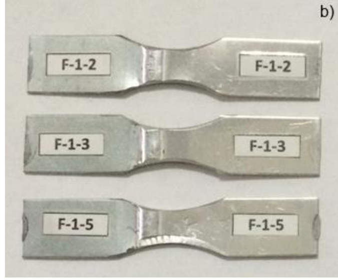
Şekil 4.10.(Devam) (a) Eğmeli yorulma makinası ve (b) yorulma numunesi
