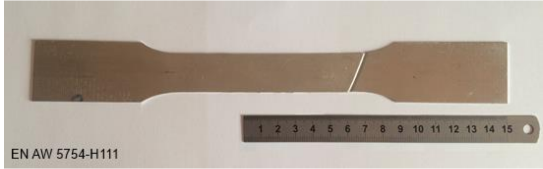
Şekil 5.2. EN AW 5754-H111 çekme testi numunesi
