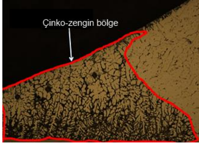
Şekil 3.19. Kaynak metalindeki çinko-zengin bölge
