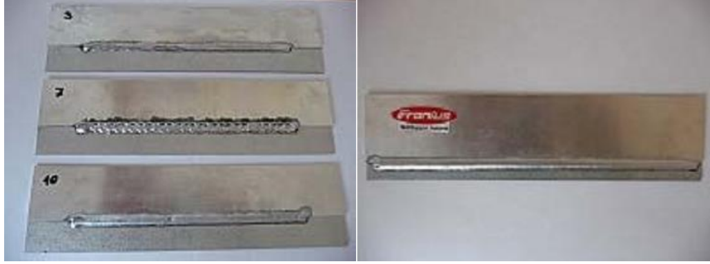
Şekil 3.16. Farklı parametreler ile birleştirilmiş metallerin kaynak dikiş görüntüleri ve örnek birleştirme
