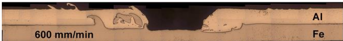
Şekil 2.5. FSSW yöntemi ile birleştirilmiş alüminyum ile çelik levha kesit görüntüsü (Chen ve diğ., 2012)
