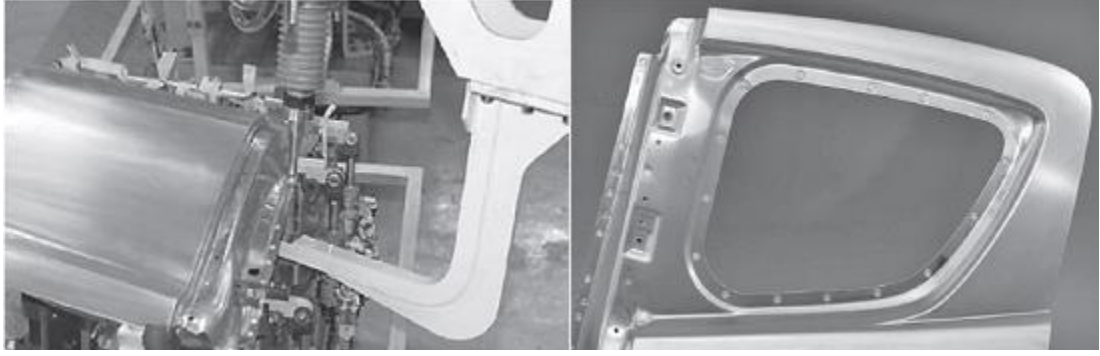
Şekil 2.6. Robotik FSSW uygulanan Mazda RX-8 arka kapısı ve dış panel görüntüsü (Lohwasser ve Chen, 2010)
