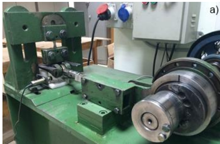
Şekil 4.9. (a) Eğmeli yorulma makinası ve (b) yorulma numunesi
