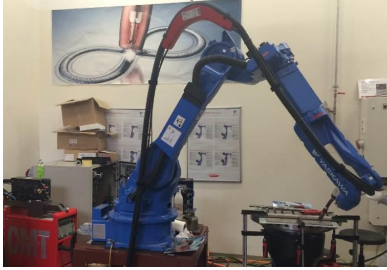
Şekil 4.3. Sinerjik robotik CMT kaynağının uygulanması
