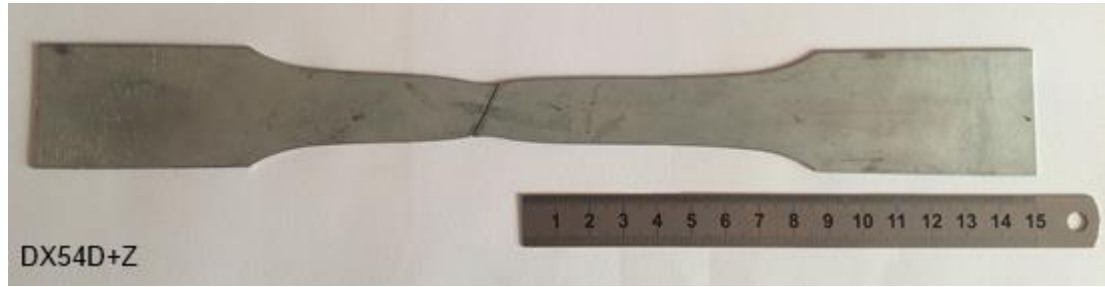
Şekil 5.3. DX54D+Z Galvanize çelik çekme testi numunesi
