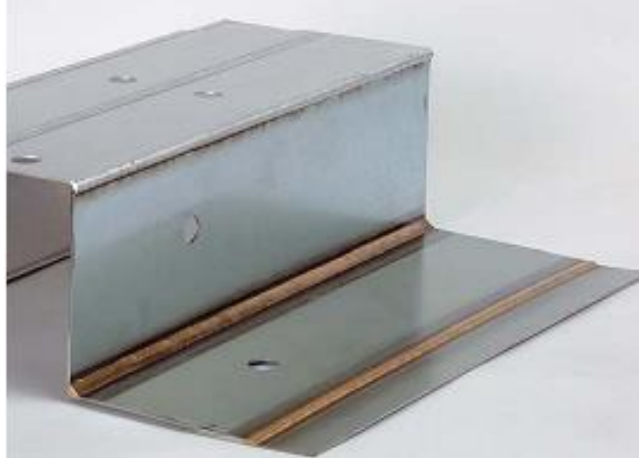
Şekil 2.19. Daldırma galvaniz ile kaplanmış çelik ile elektro galvaniz kaplanmış 1 mm kalınlığındaki çelik sacların CuSi3 dolgu metali ile CMT lehim görüntüsü
