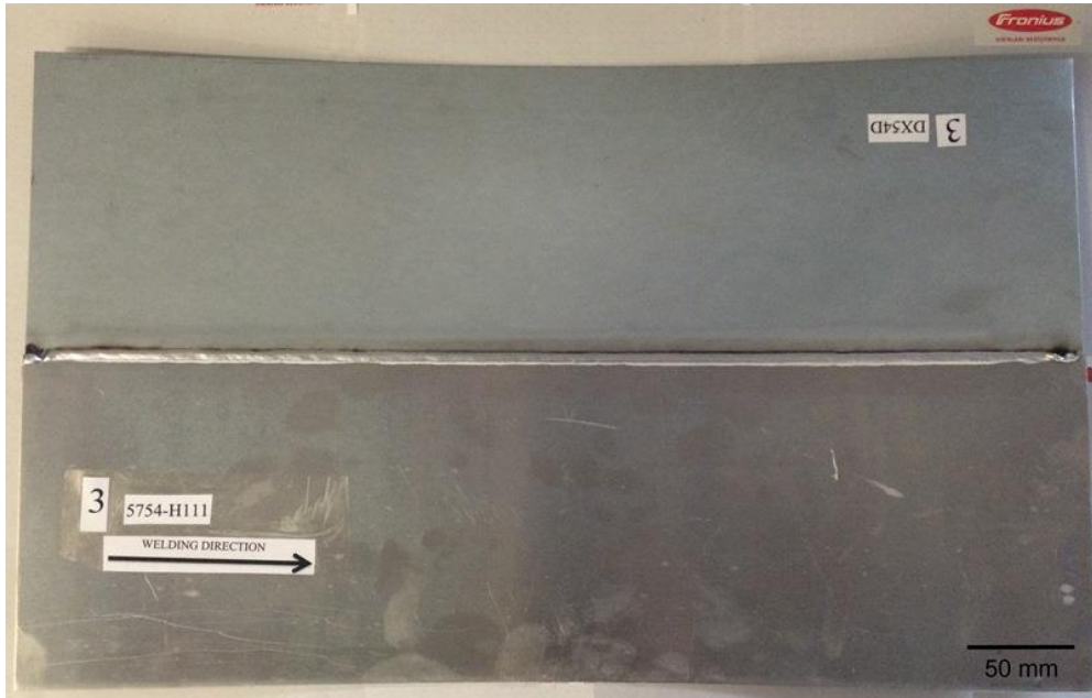
Şekil 4.4. Robotik CMT kaynağı sonrası kaynak dikişinin görünüşü
