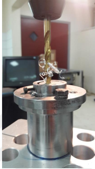
Şekil 6.39. HSS-G TiN matkap ucu ile konvansiyonel delme sırasında oluşan talaş sarılması
