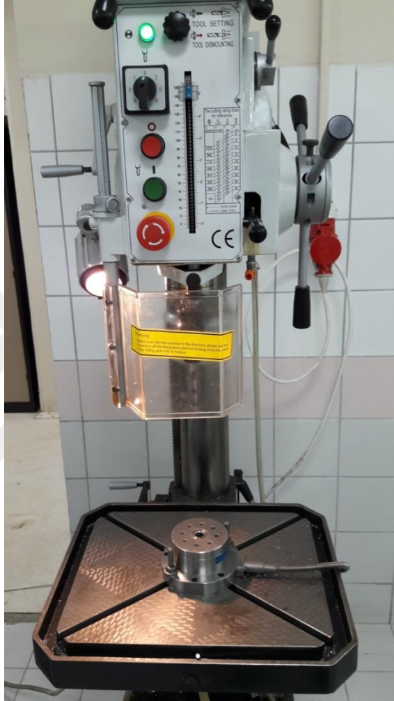
řekil 6.10. Delme dinamometresinin matkap tablasına bađlanması
