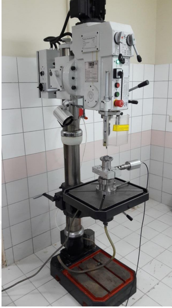
Şekil 6.11. Ultrasonik titreşim platformunun delme dinamometresinin üzerine bağlanması
