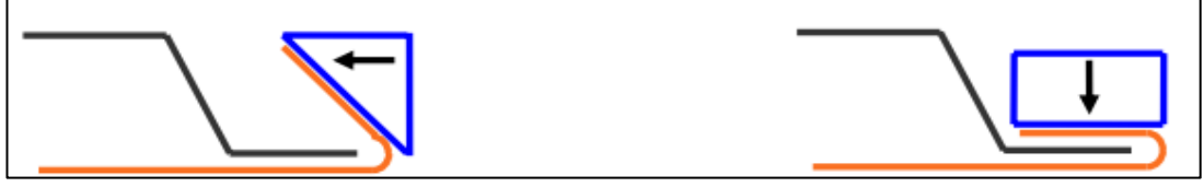
Şekil 2.17. Solda ön katlama sağda son katlama olmak üzere hareket yönleri kalıp üzerine dikey yöndedir.
