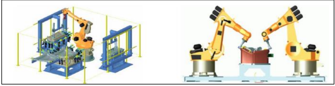
Şekil 2.23. Solda: üç farklı parça (tavan ve kapılar) aynı robot ile katlanmakta, sağda: İki robot bir parçanın farklı taraflarında çalışmakta [12]
