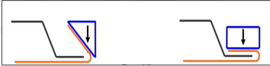
Şekil 2.14. Solda ön katlama sağda son katlama makara kuvvet yönleri
