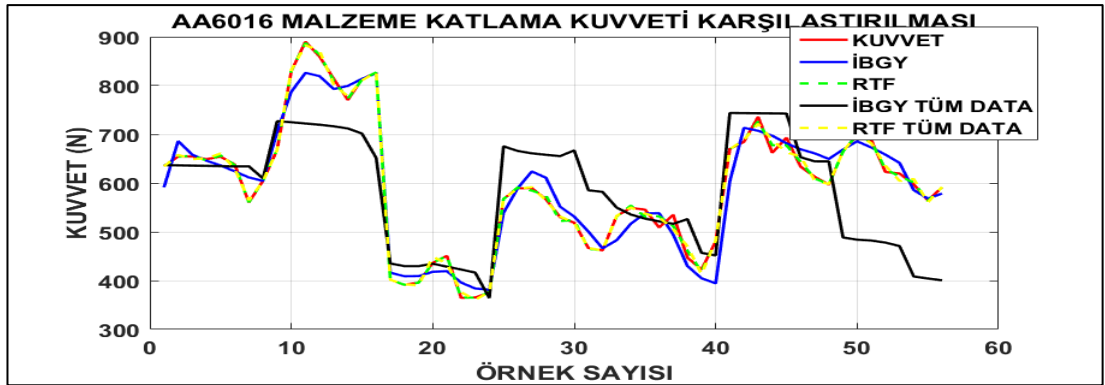
Şekil 5.15. AA6016 malzeme ve tüm data bazında sonlu elemanlar yöntemi ile elde edilen, İBGY yöntemi elde edilen ve RTF model ile elde edilen son katlama kuvvet değerlerinin karşılaştırılması
