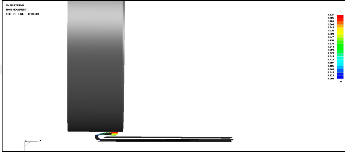
Şekil 2.56. X yönündeki içe kaymalar: Makara çapı 90 mm, son katlama, AA6111 malzeme
