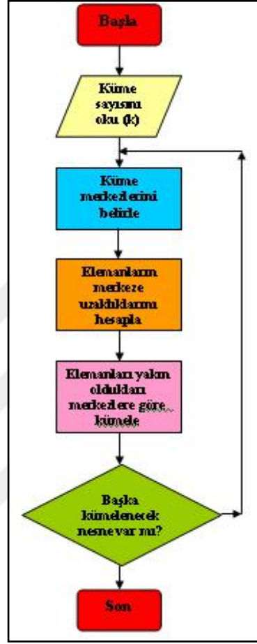
Şekil 1.38. K-means algoritmasının adımları
