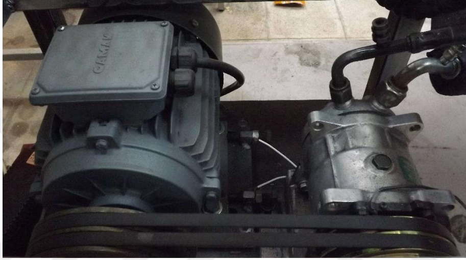
Şekil 2.3. Deneysel sistemde kullanılan kompresörün elektrik motoruna bağlanmış durumdaki fotoğrafı
