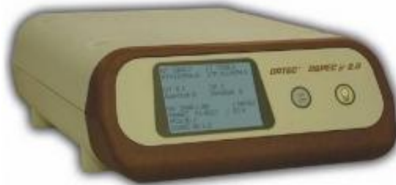
Şekil 3.6. Gama Spektroskopi Sistemindeki Kompakt elektronik birim (ORTEC DSPEC jr 2.0-POSGE)
