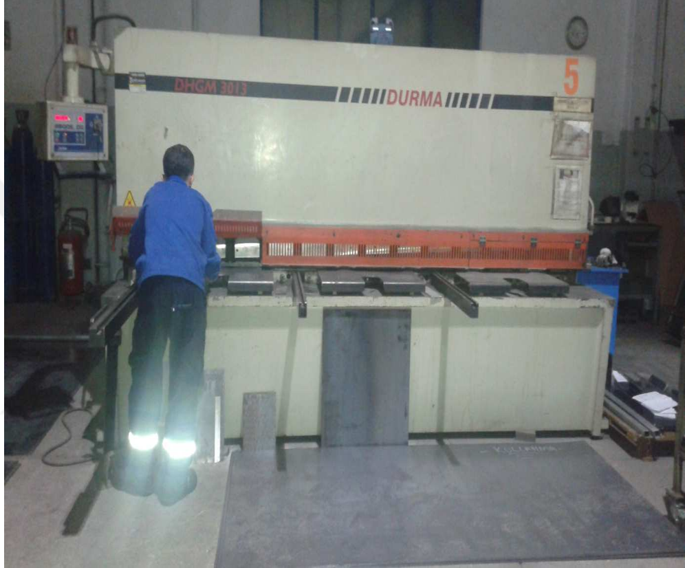
Şekil 6.4. İş parçası malzemesinin hassas kesimi için kullanılan hidrolikle tahrik edilen giyotin metal kesme makinesi
