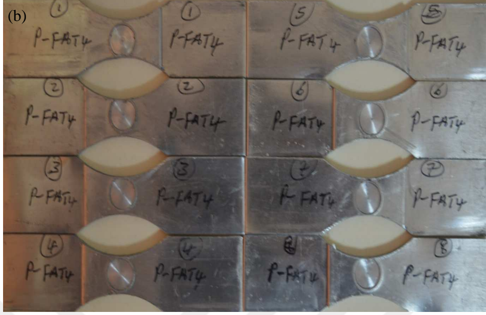
Şekil 6.15. (Devam) Kaynaklanmış bağlantılarından üretilen yorulma test numuneleri: (a) konik pimli olan numune; (b) pimsiz olan numune
