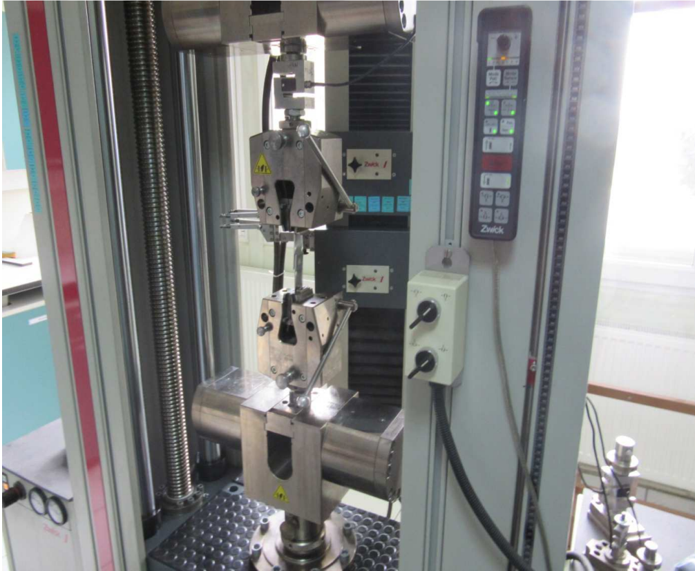
Şekil 6.17. Çekme makinesindeki nokta kaynaklı AA2219-O numunesinin çekme kesme testi işlemi
