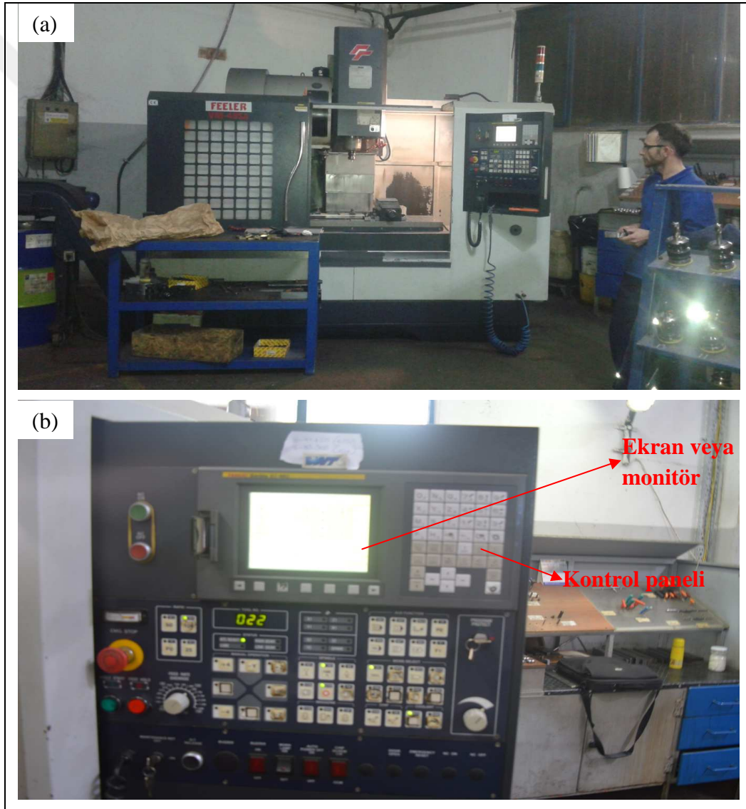
Şekil 6.6. Adapte edilen sürtünme karıştırma nokta kaynak makinesi: (a) Sürtünme karıştırma nokta kaynağı işlemi için CNC freze makinesi; (b) Proses parametrelerinin otomatik ayarlanması için kontrol paneli
