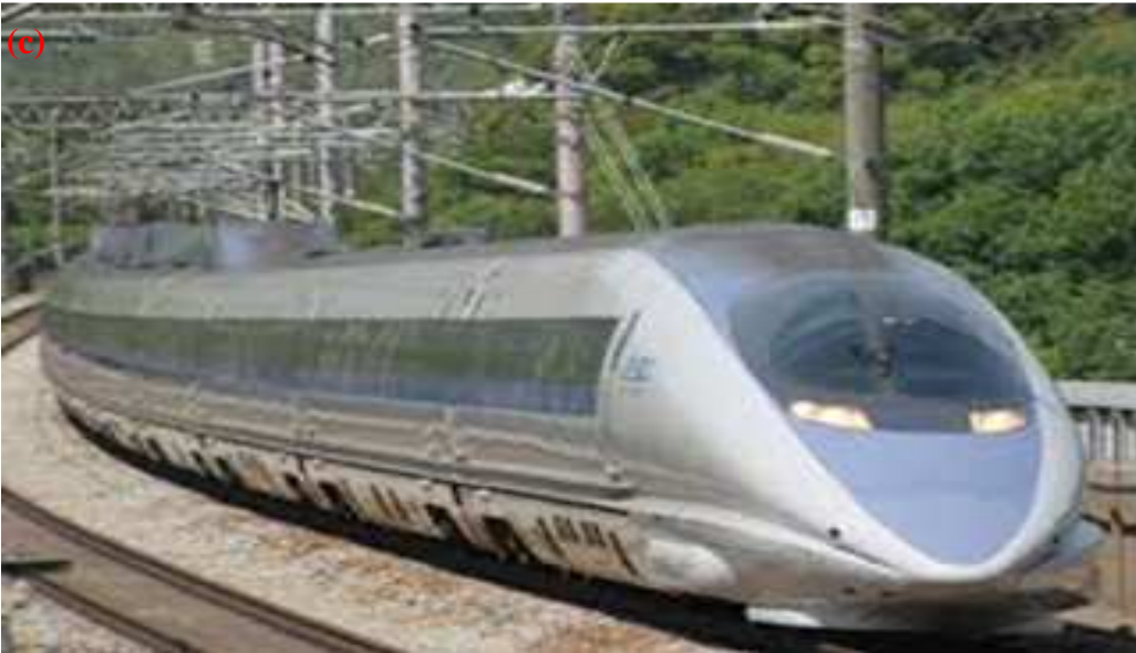
Şekil 2.12. Alüminyum alaşımından üretilen uçak, gemi ve tren (a) A380 uçağı [62]; (b) Yolcu gemisi [79]; (c) kurşun hızında trenin alüminyumlu gövde kabuğu [80]
