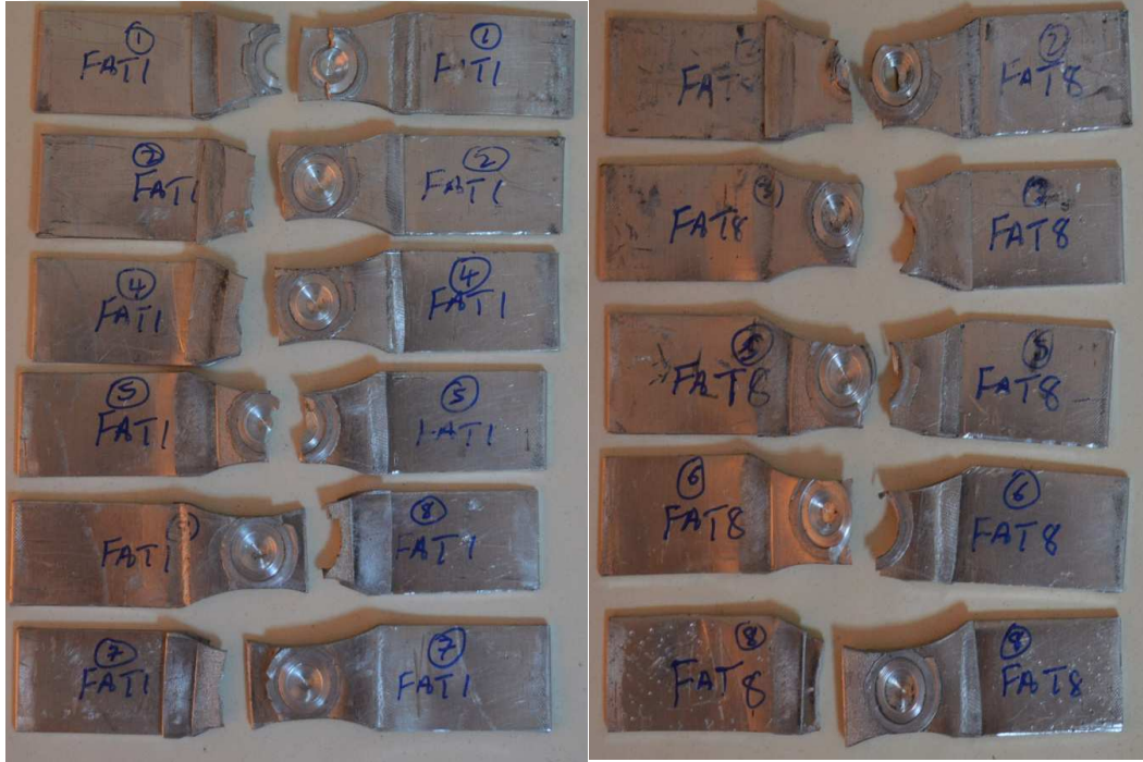
Şekil 7.54. Çevrimsel yükleme altında konik pim destekli bağlantıların kırılma deseni
