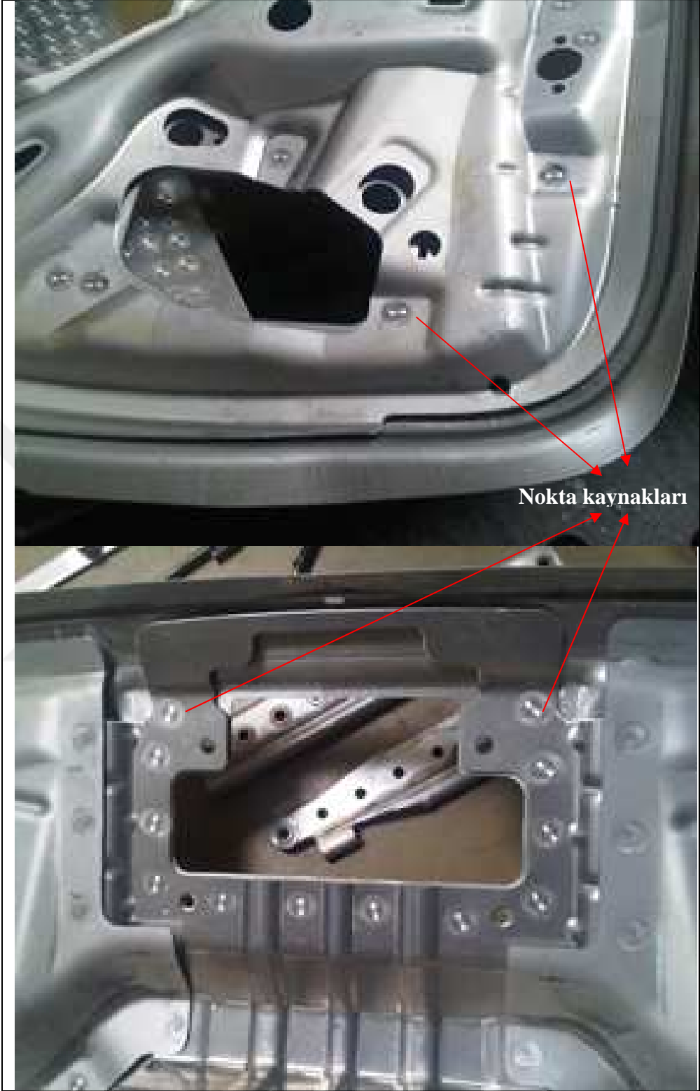
Şekil 3.3. Yeniden doldurulmalı sürtünme karıştırma nokta kaynağı teknolojisinden oluşturulmuş alüminyum-magnezyum nokta kaynakları [124]
