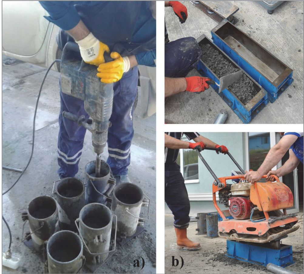
Şekil 2.4. Titreşimli tokmak (a), titreşimli plakalı zemin sıkıştırıcısı (b)
