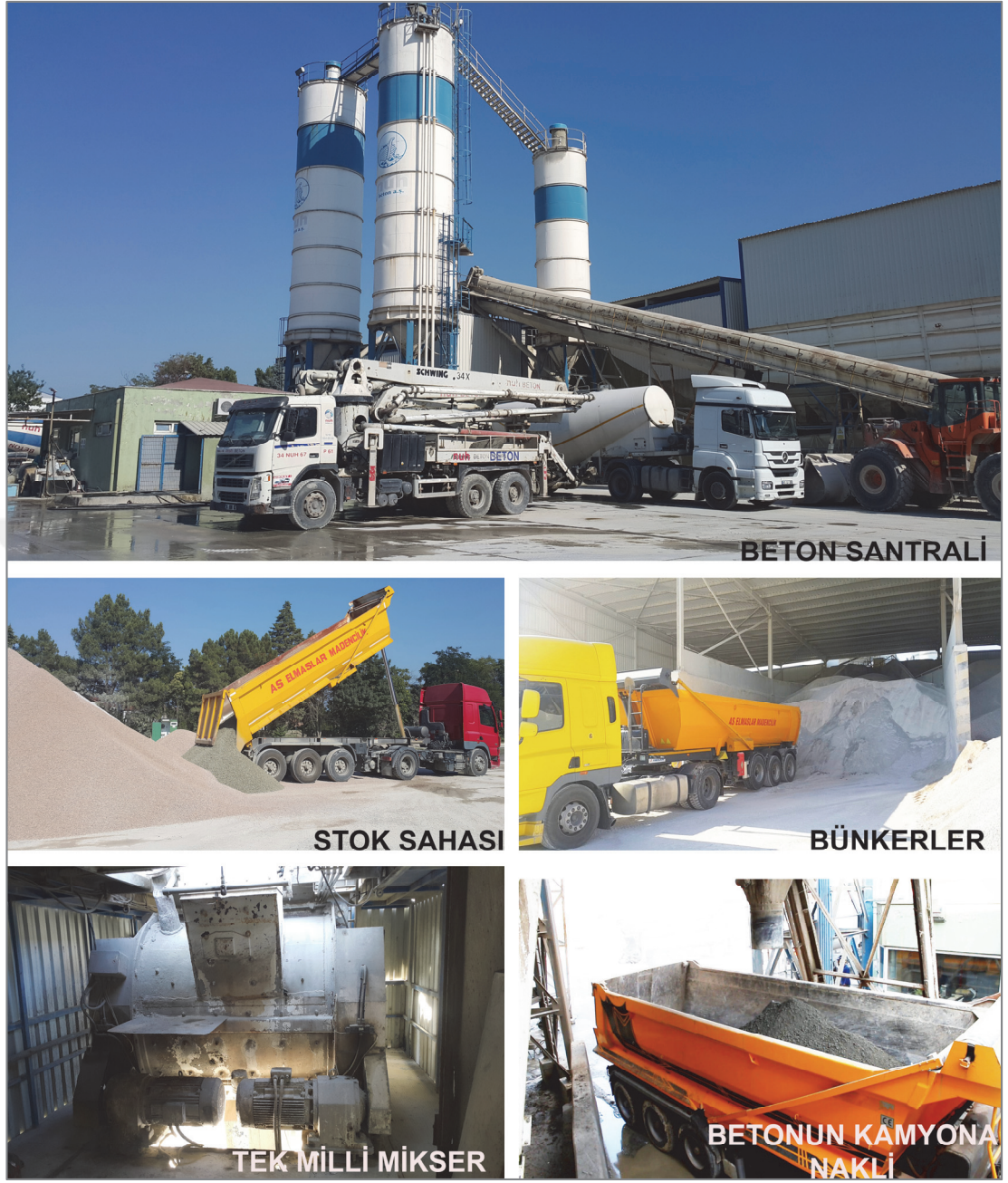
Şekil 3.6. Beton santrali ve üretim prosesinden birkaç bölüm
