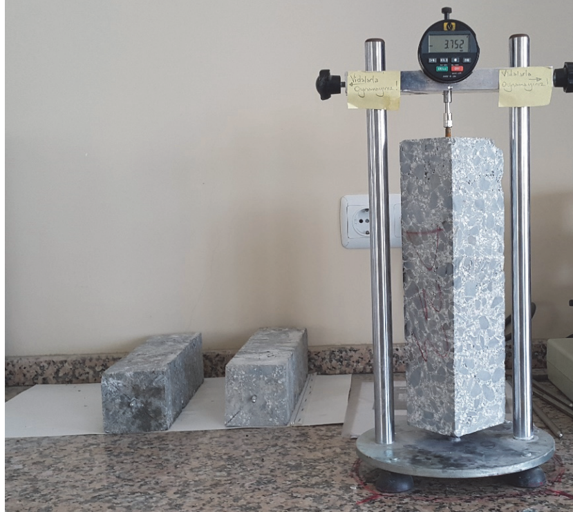
Şekil 2.9. Kuruma rötresi tayininde kullanılan numuneler ve test düzeneği
