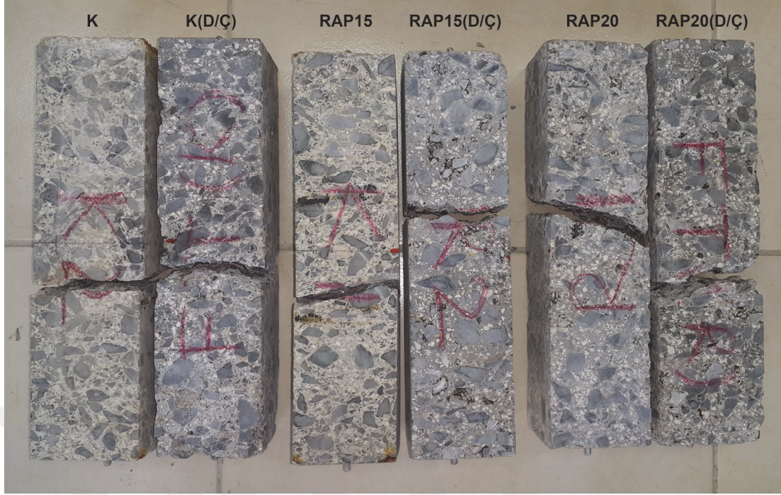
Şekil 2.21. Numunelerin eğilme deneyinden sonrasındaki görüntüleri
