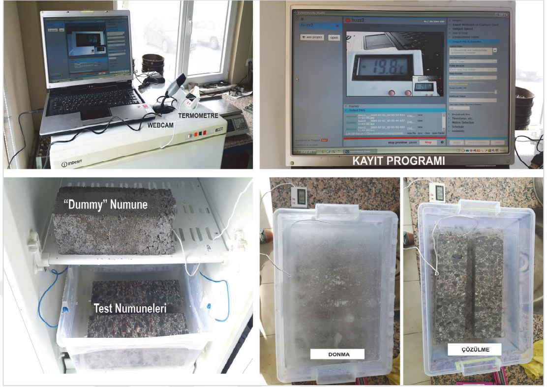
Şekil 2.13. Donma/çözülme döngüsü için kurulan sistem
