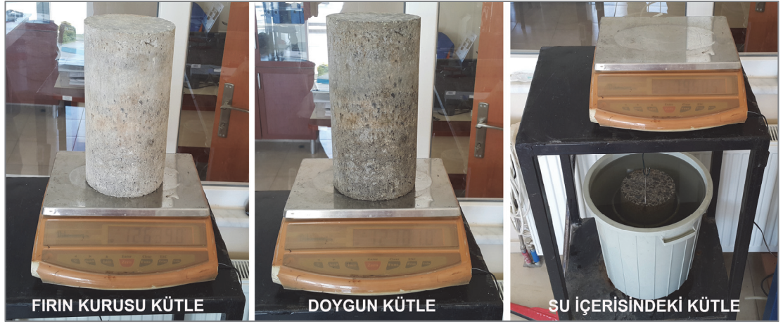
Şekil 2.5. Kuru birim ağırlık ve kütlece su içeriğinin belirlenmesi (ASTM C642)
