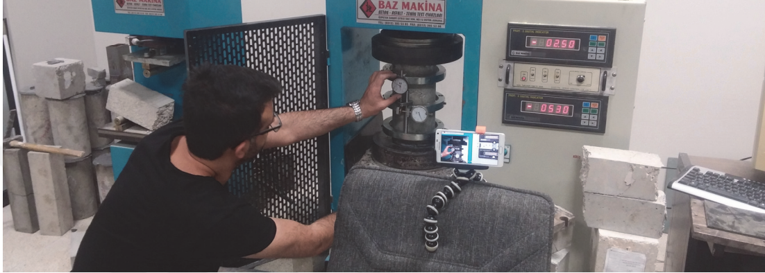
Şekil 2.7. Elastisite Modülü test düzeneği
