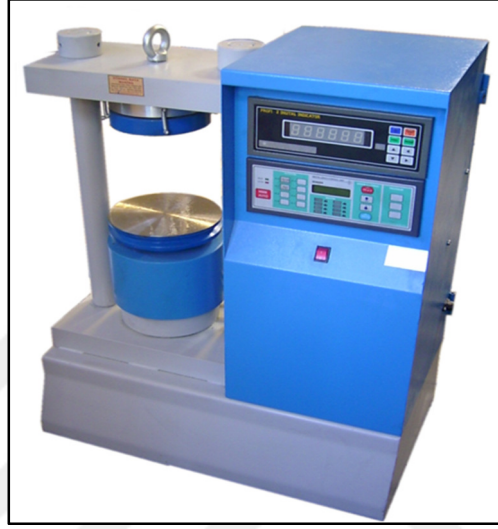
Şekil 3.17. Tek eksenli sıkışma deney düzeneği
