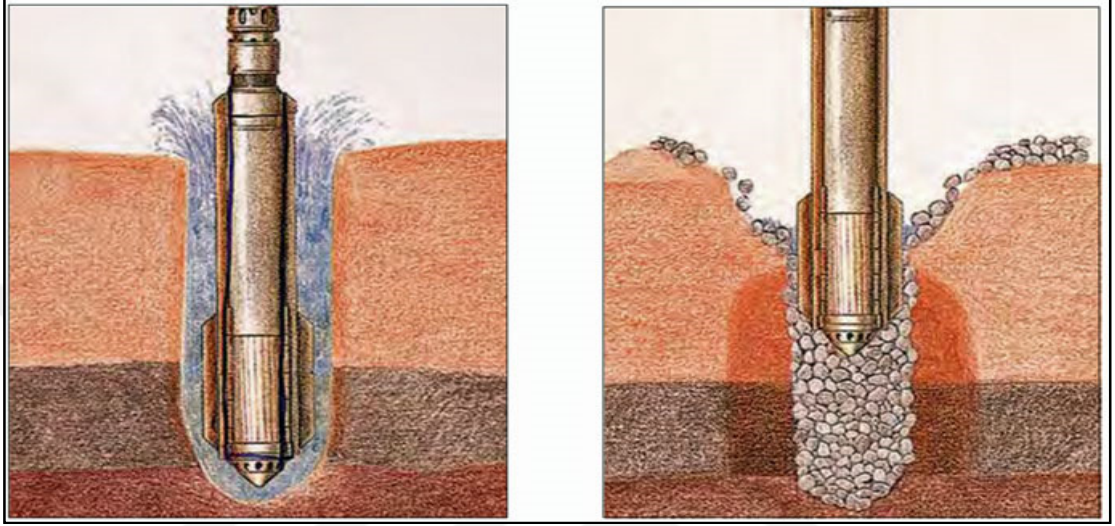
Şekil 3.34. Taş kolon ıslak uygulama
