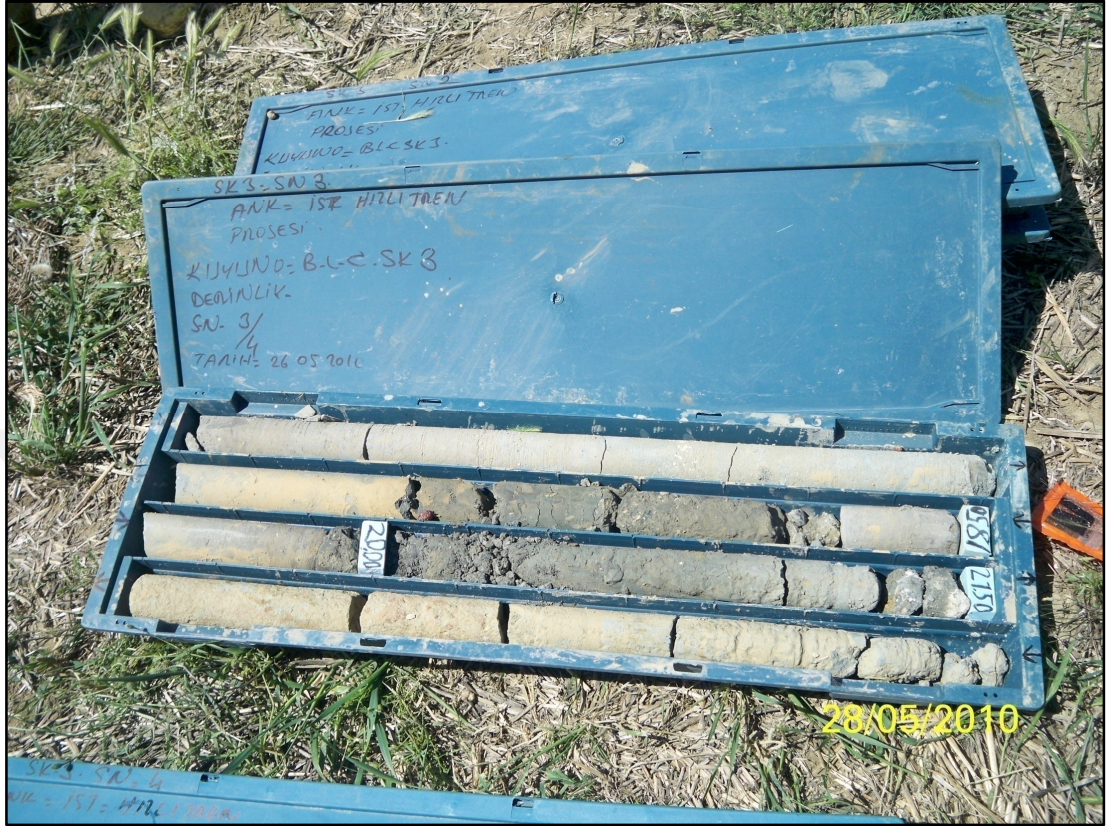
Şekil 3.4. Karot sandıkları, numaralandırılması ve karot yerleşimi
