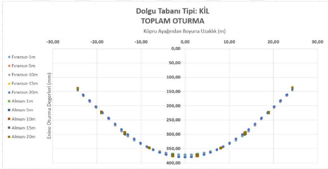
Şekil 6.28. Kil tabanlı yaklaşım dolgularında enine kesitte gerçekleşen toplam oturma değerleri
