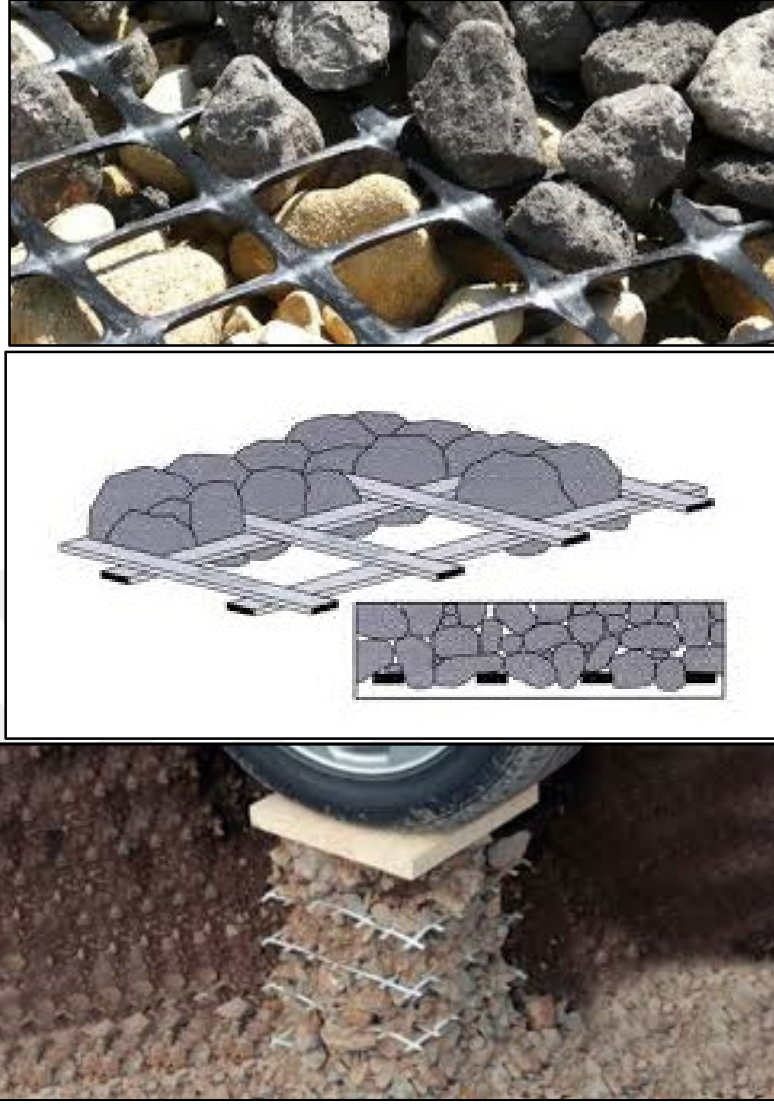
Şekil 3.44. Geogridlerin kenetlenme prensibi ve yanal hareketleri önlemesi
