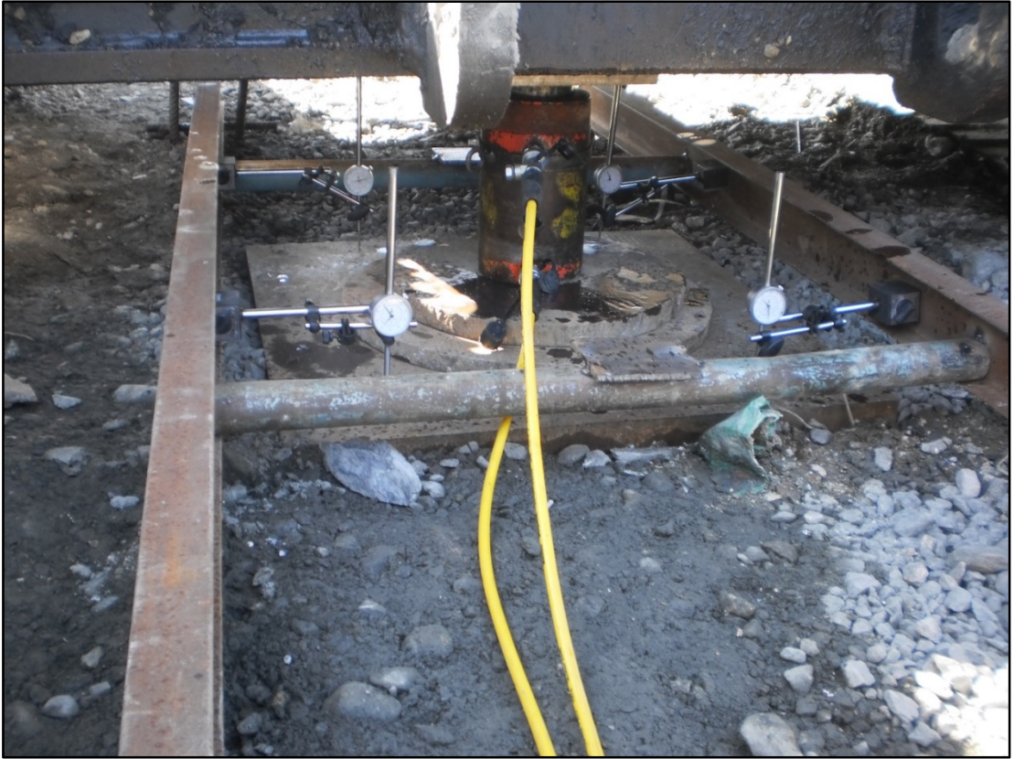
Şekil 3.38. Taş kolon Taş kolon yükleme deneyi
