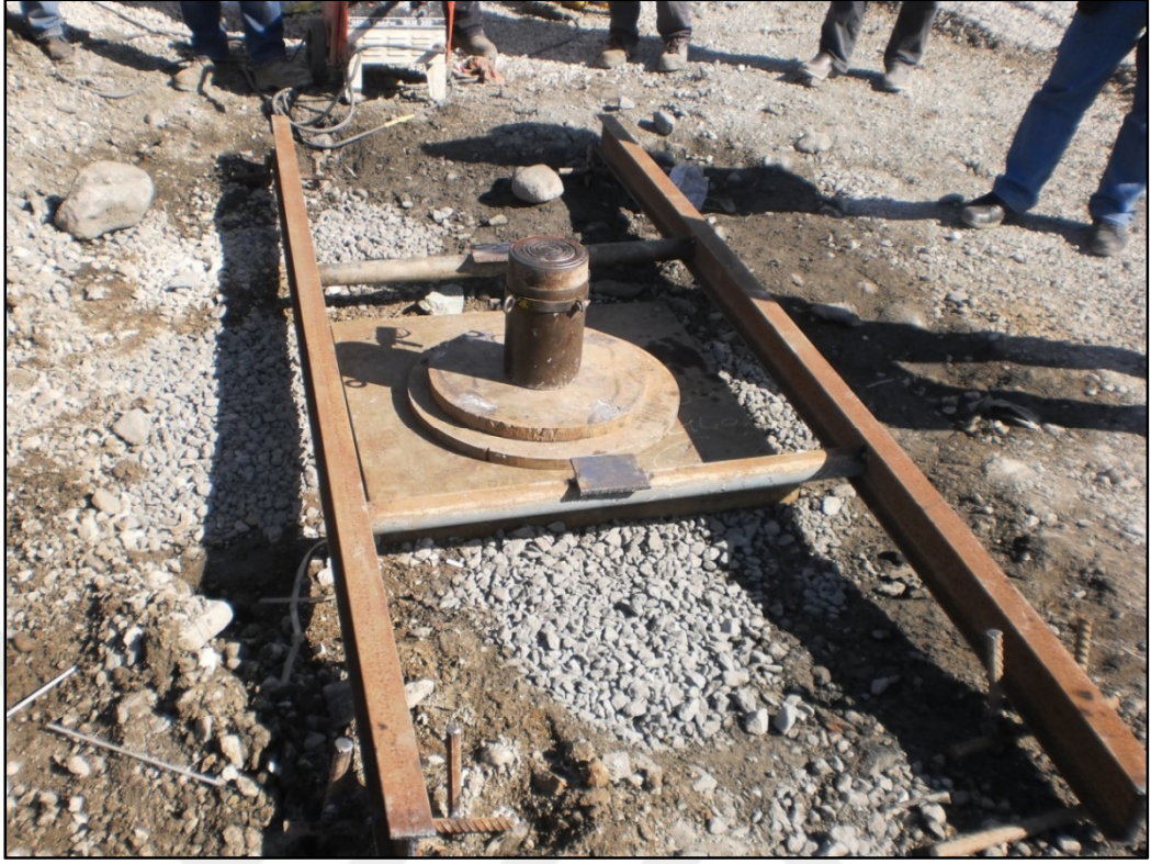
Şekil 3.35. Taş kolon yükleme deneyi
