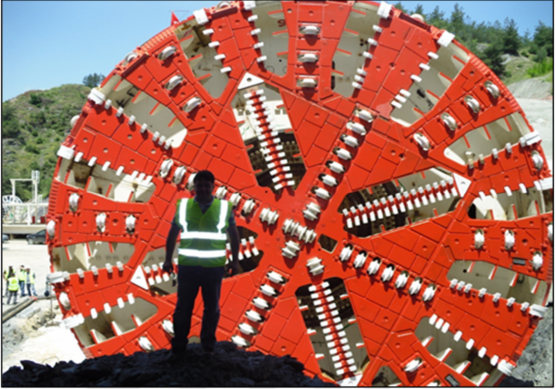
Şekil 2.17. Yüksek hızlı demiryolu yapımında kullanılan TBM'in kesici kafa ön görünüşü
