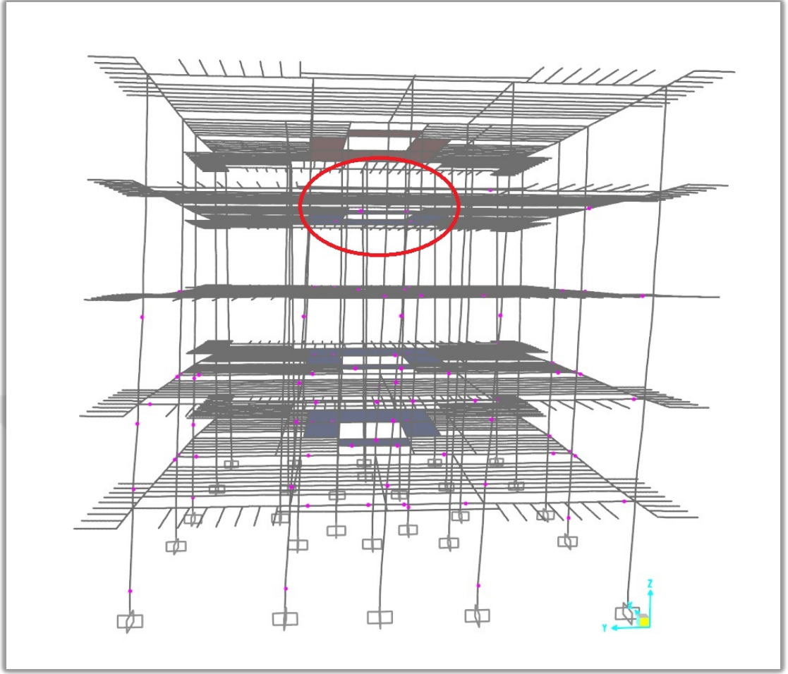
Şekil 5.4. Eşdeğer deprem yükü metoduyla bulunan y yönlü mafsallaşma
