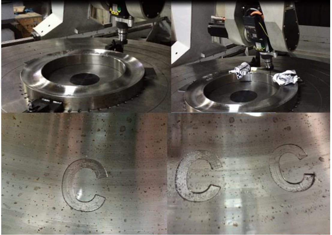
Şekil 4.5. Çelik yüzey üzerine işlenen örnek karakter görüntüleri
