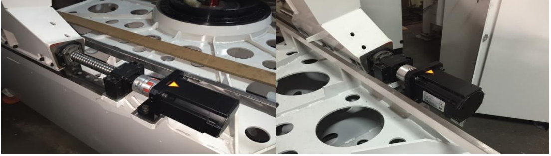
Şekil 2.24. Prototip CNC’de kullanılan Y eksen motorlarının farklı açılardan görüntüleri
