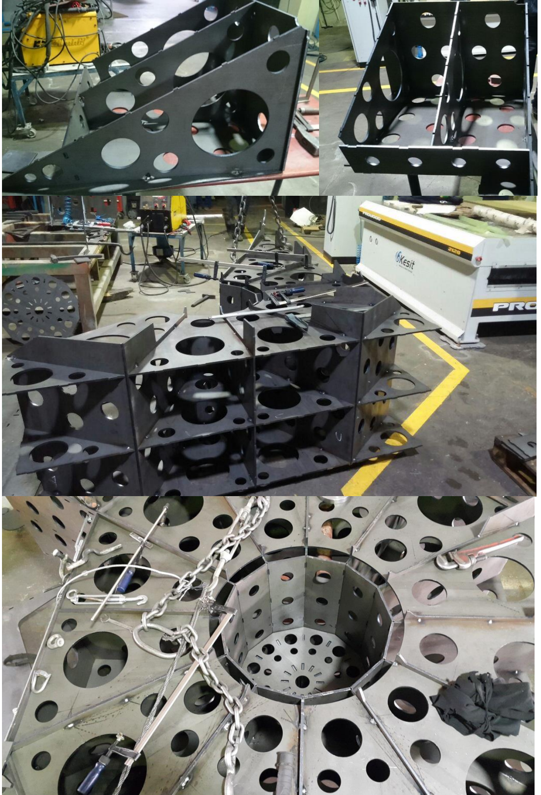
Şekil 2.13. Prototip makinenin mekanik gövde imalatından bazı görüntüler
