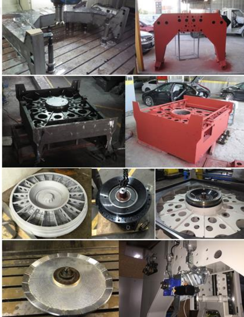
Şekil 4.1. Prototipi gerçekleştirilen CNC makinesinin prototip imalat aşama görüntüleri
