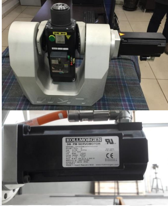
Şekil 2.26. Prototip CNC’de kullanılan A eksen motor görüntüleri
