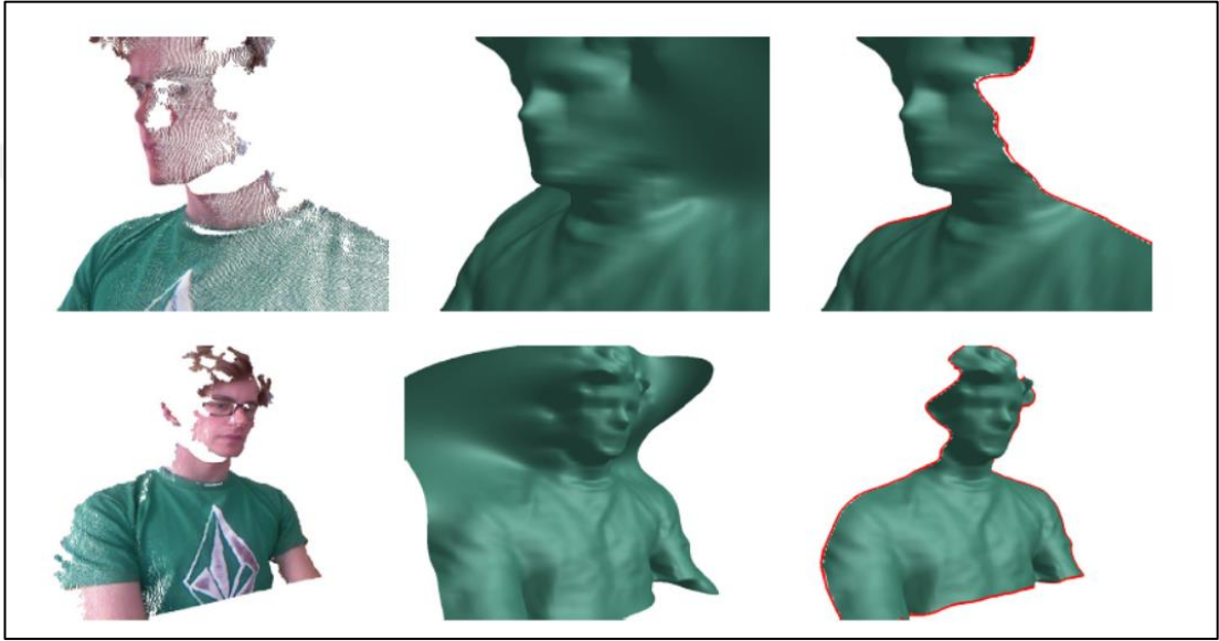
Şekil 1.10. Nokta bulutları ile gösterilmiş bir resmin önerilen metot ile (B-spline) yüzeylere dönüştürülmesine ait görüntüler [44]
