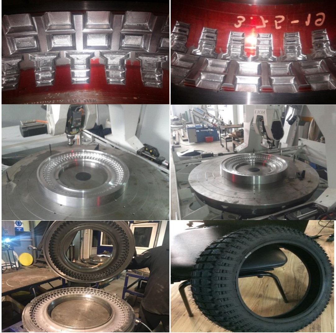
Şekil 4.10. Prototip CNC makine ile örnek kalıp ve karakter işleme görüntüleri
