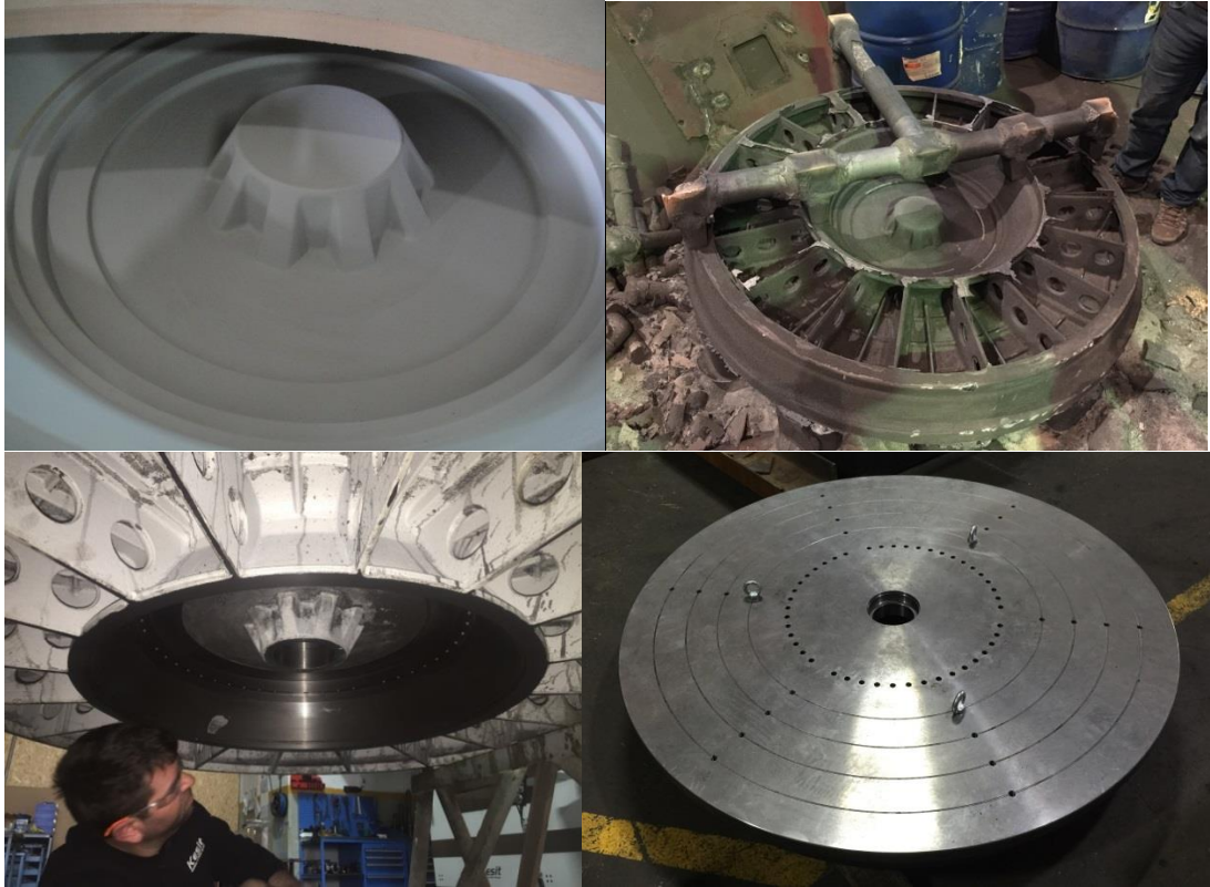
Şekil 2.17. Döner tabla imalatı aşamalarının görüntüleri
