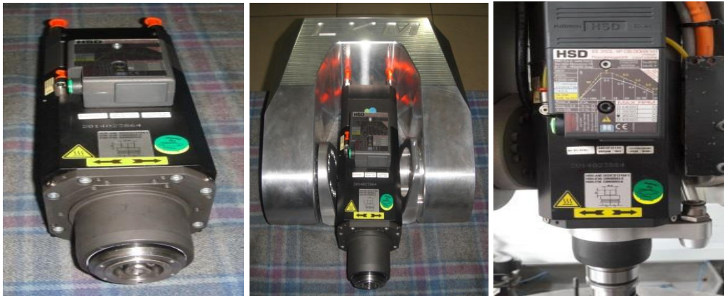
Şekil 2.28. Prototip CNC’de kullanılan spindle motor görüntüleri
