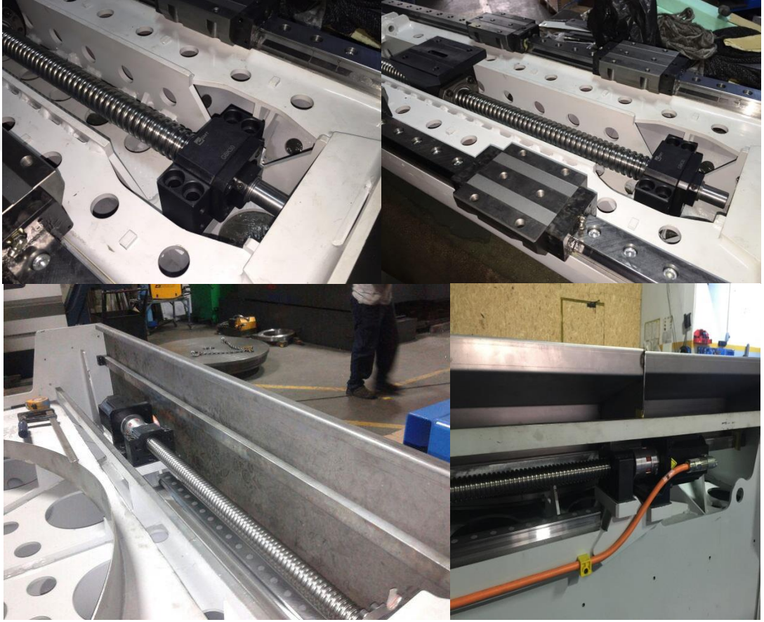
Şekil 2.22. Kızaklar ve sonsuz vidalardan bazı görüntüler
