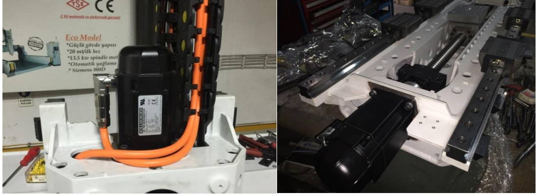
Şekil 2.25. Prototip CNC’de kullanılan Z eksen motorun farklı açılardan görüntüleri
