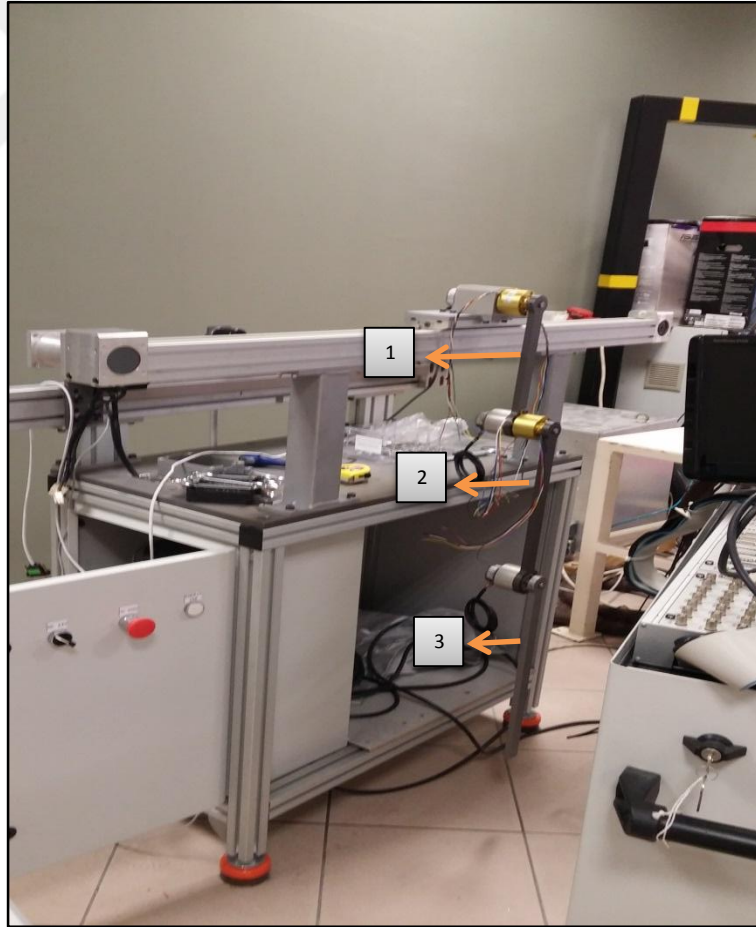
Şekil 2.22. Arabalı çok çubuklu ters sarkaç sisteminin fiziksel mekanizması
