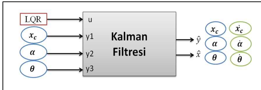
Şekil 5.20. KF durum tahmini çalışma yapısı
