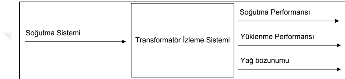
Şekil 1.23. Soğutma sistemi ve arıza ilişkisi
