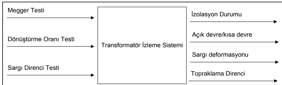
Şekil 1.26. Megger, dönüştürme oranı ve sargı direnci testleri ile arıza ilişkisi
