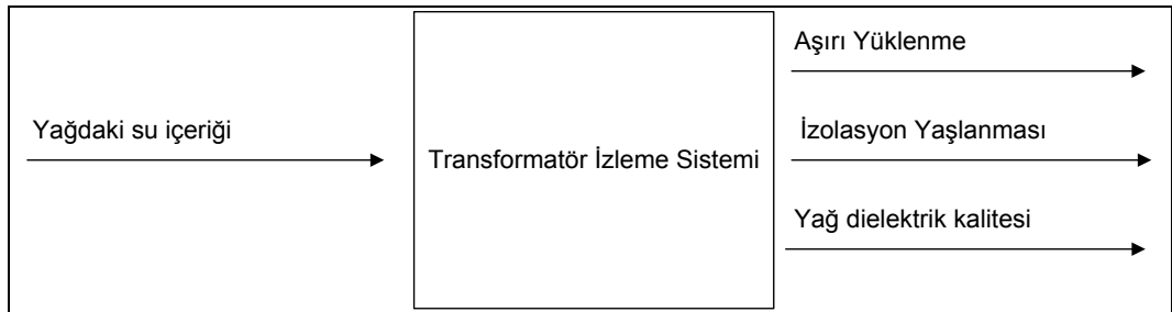
Şekil 1.21. Yağdaki su içeriği ve arıza ilişkisi
