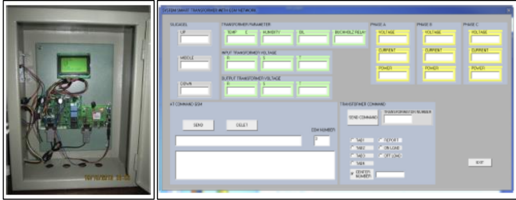
Şekil 1.11. İzleme sisteminin donanım ve yazılım katmanları [15]
