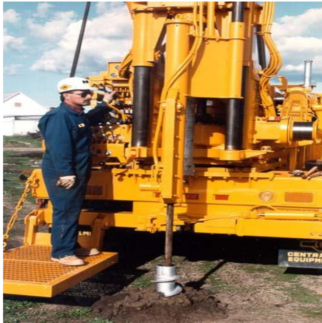
Şekil 1.3. Otomatik tip şahmerdan
