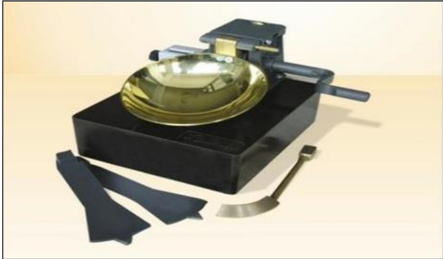
Şekil 3.2. Likit Limit deney seti
