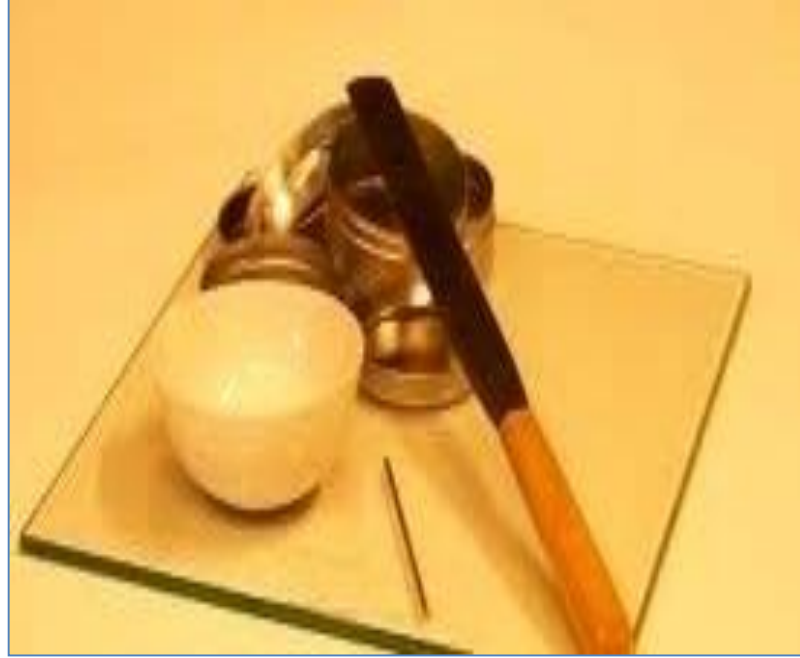
Şekil 3.3. Plastik Limit Deney Seti
