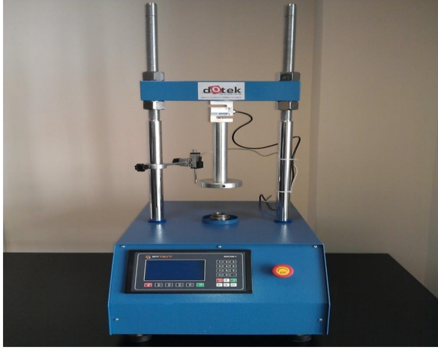
Şekil 3.6. Tek eksenli basınç deney seti
