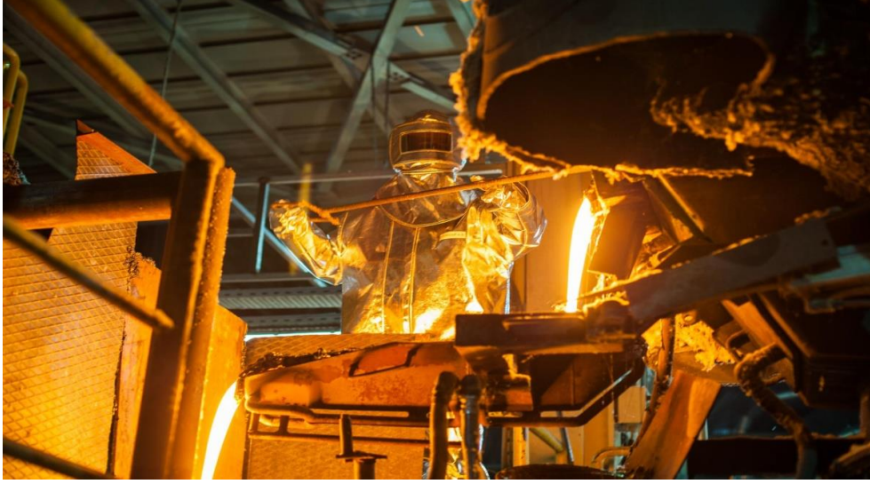
Şekil 3.3. Kupola fırınından 1400°C de akan camın görüntüsü
