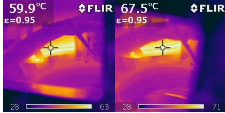
Şekil 3.45. Çift sargılı elektrik makinası sıcaklık dağılım fotoğrafları
