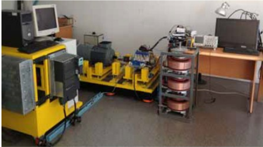
Şekil 5.11. Çift sargılı elektrik makinası deneysel test düzenegi
