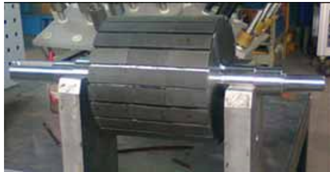
Şekil 3.48. Çift sargılı elektrik makinası rotor yapısı ve yüzey montajlı mıknatıslar
