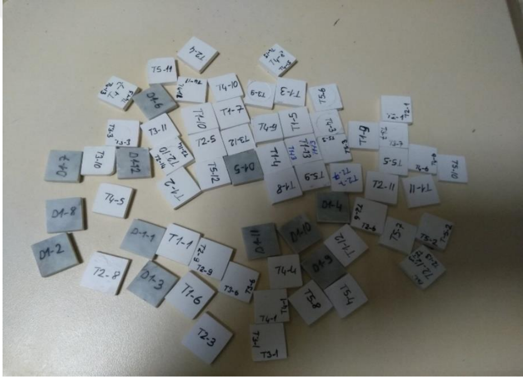
Şekil 5.1. Aşınma testi için hazırlanmış numuneler
