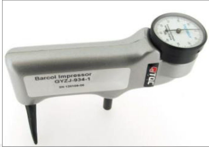
Şekil 5.3. Barcol sertlik ölçüm cihazı [94]
