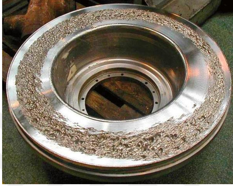
Şekil 4.4. Eroziv aşınma mekanizması [61]
