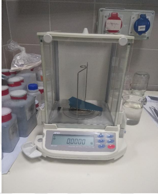
Şekil 5.2. AND GR-200 yoğunluk ölçüm cihazı
