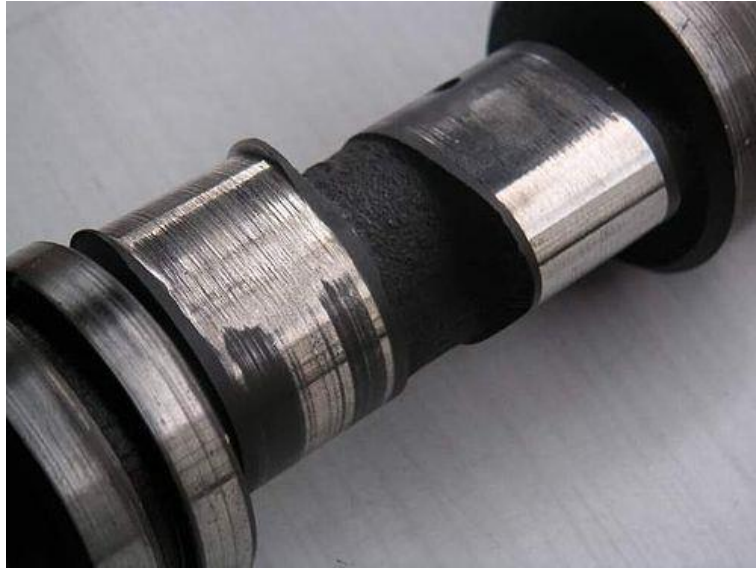
Şekil 4.3. Bir kam mili üzerinde zamanla oluşmuş adheziv aşınma ve abraziv aşınma mekanizmaları [58]
