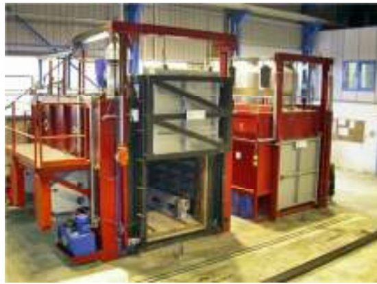
Şekil 6.3. Döküm biyetlerin homojenize edildiği homojenizasyon fırını
