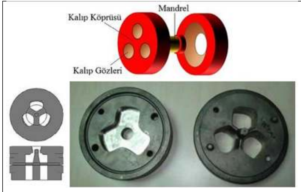
Şekil 4.20. Köprülü sıcak ekstrüzyon kalıbının şematik ve gerçek gösterimleri
