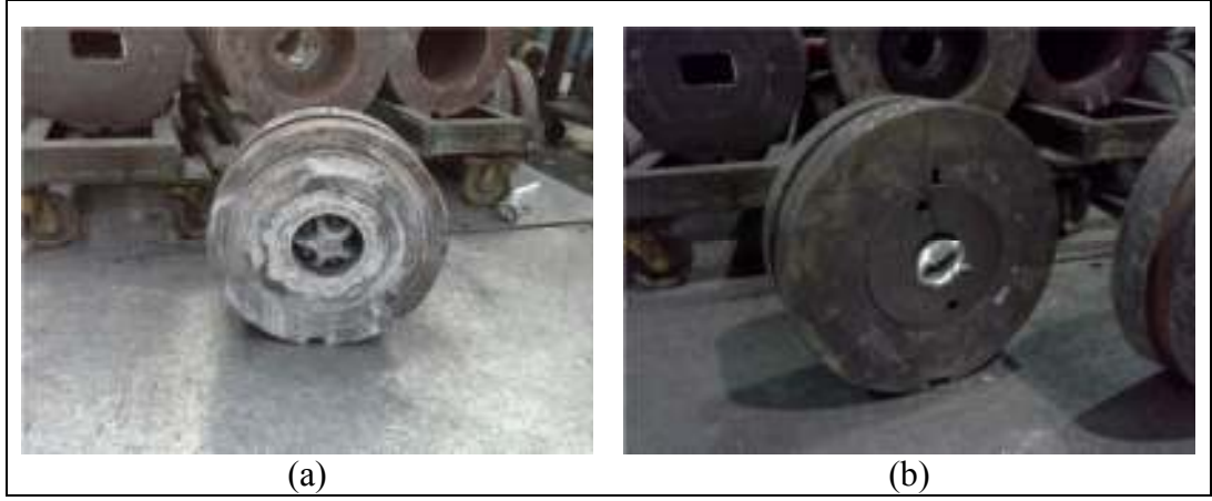
Şekil 6.9. Alaşımın ekstrüzyonunda kullanılan köprülü ekstrüzyon kalıpları
