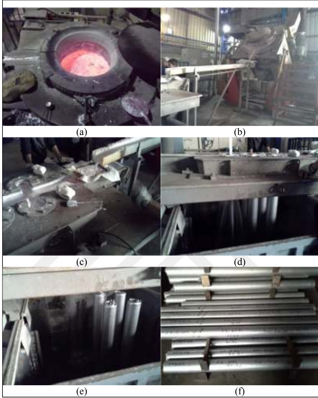
Şekil 6.1. Doğrudan soğutmalı yarı sürekli döküm yöntemi ile alaşımların dökümü; a) gaz ocağında ergitme, b, c) yolluk yardımı ile sıvı metalin kalıba aktarılması, d, e) biyet şeklinde döküm işlemi, f) döküm konumundaki biyetler
