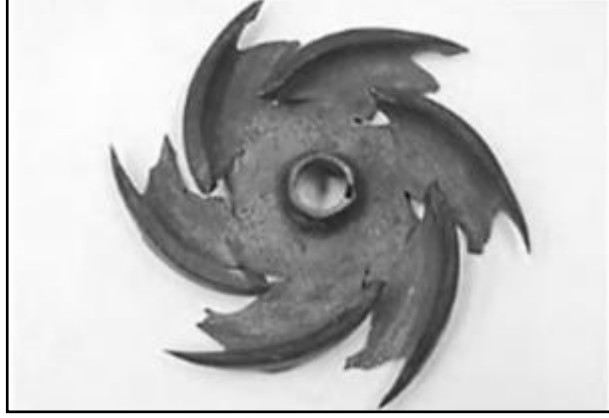
Şekil 3.1. Bir maden pompasının çarkındaki erozif aşınma [20]
