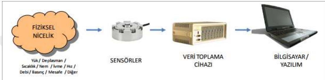
Şekil 2.2. Veri toplama süreçlerinde kaydedilen adımların gösterimi
