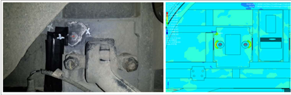
Şekil 2.10. Süspansiyon bölgesinde konumlandırılan strain-gaugeler
