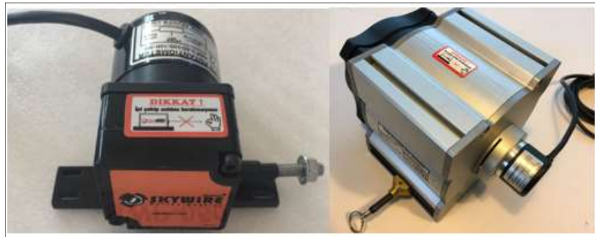
Şekil 2.6. Ömür dayanım testlerinde kullanılan deplasman ölçerler
