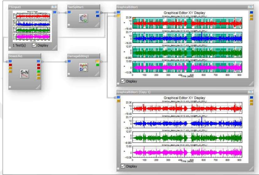
Şekil 3.1. Stresslife yöntemi ile sinyal kısaltma işleminin blok diagramı
