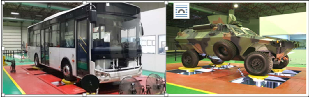
Şekil 6.1. 4Poster sisteminde gerçekleştirilen dayanım testi örnekleri
