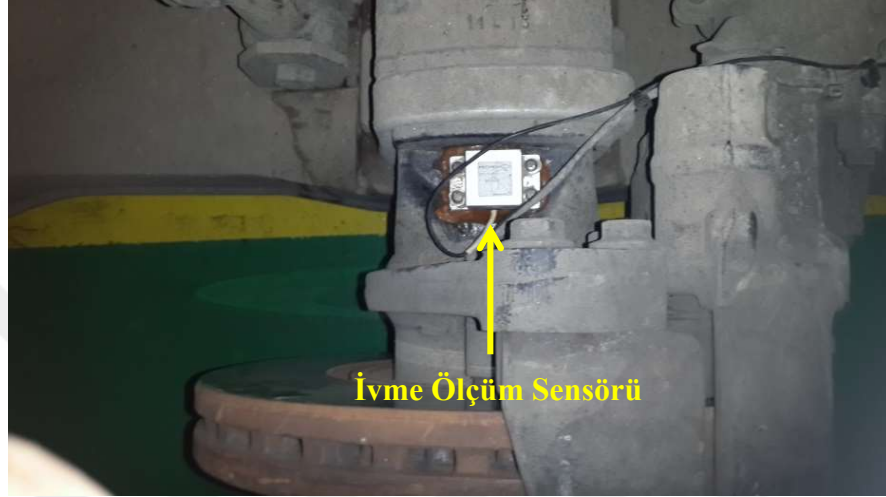
Şekil 4.7. Arka aks üzerinde yer alan üç eksenli ivme sensörleri
