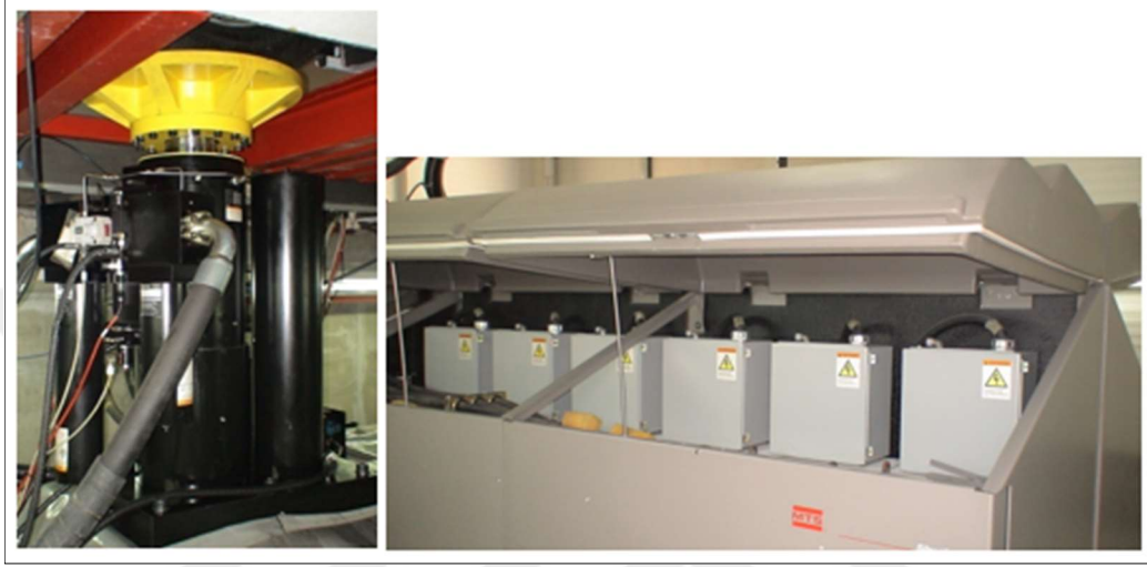
Şekil 6.2. 4Poster sisteminde ön teker eyleyicisi ve hidrolik güç ünitesi
