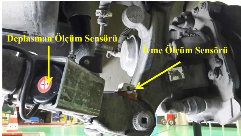
Şekil 4.6. Ön aks üzerinde yer alan ivme ve deplasman sensörleri
