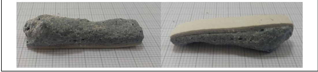
Şekil 6.40. CIP cihazında 3000 bar basınçta preslenmiş ve 1600 °C’de sinterlenmiş numune fotoğrafları
