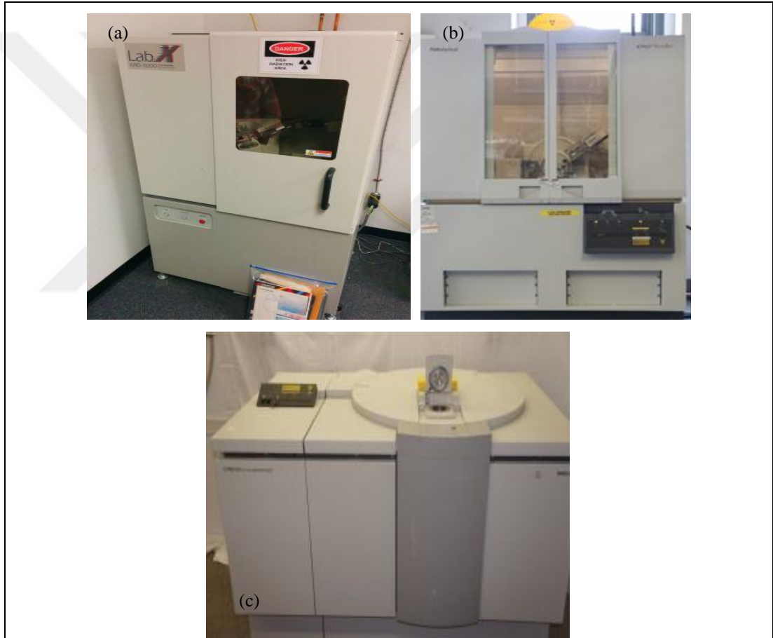
Şekil 5.1. a) Shimadzu XRD-6000 X-ışınları difaktrometre cihazı b) Panalytical Ritveld XRD cihazı c) Philips PW 2404 cihazı
