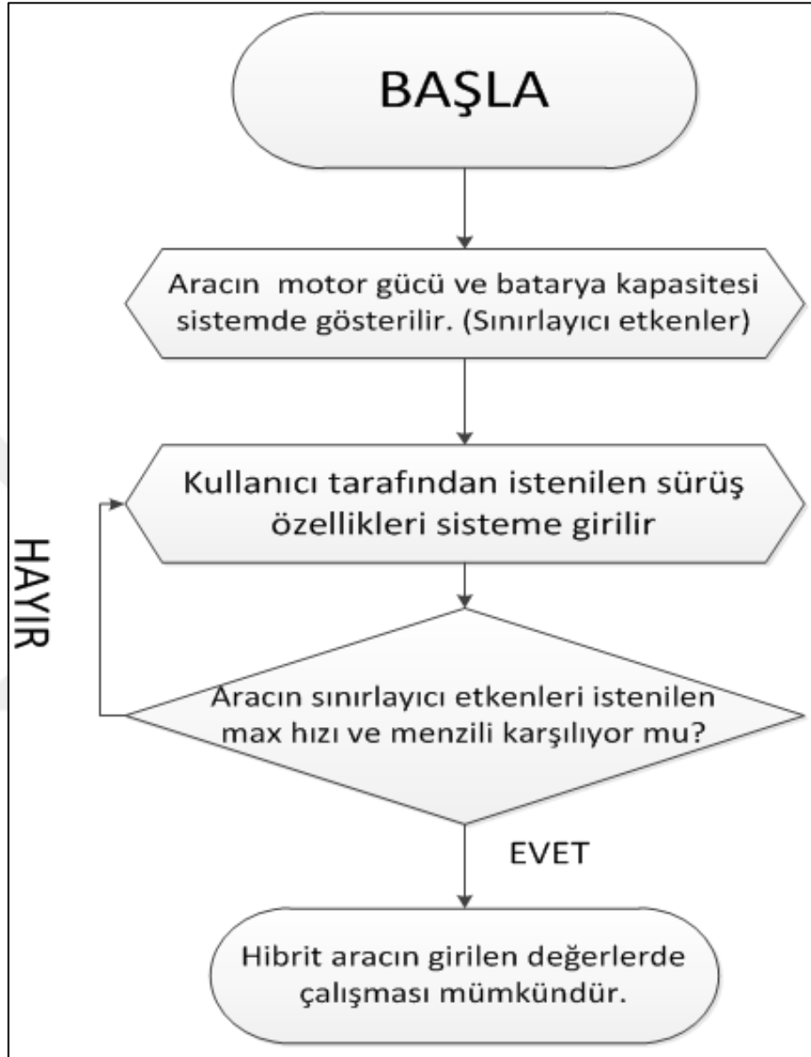
Şekil 4.3. Hibrit elektrikli araçlar için önerilen sürüş modu algoritması
