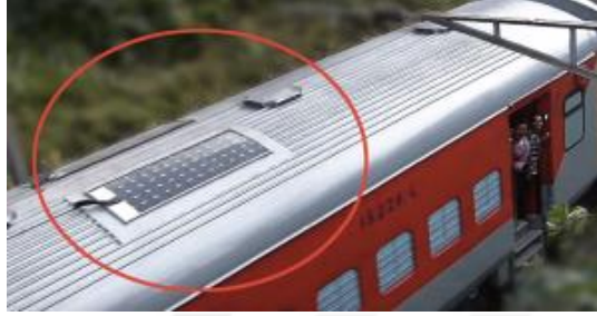
Şekil 2.17. Güneş panelinin çatıdaki yerleşimi [39]
