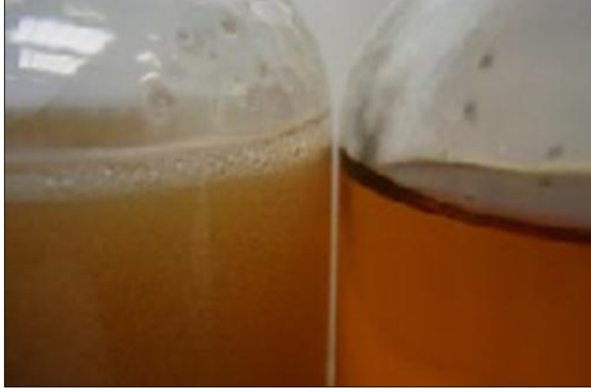
Şekil 1.19. Çözünmemiş (solda) ve çözülmüş (sağda) gazlar [29]
