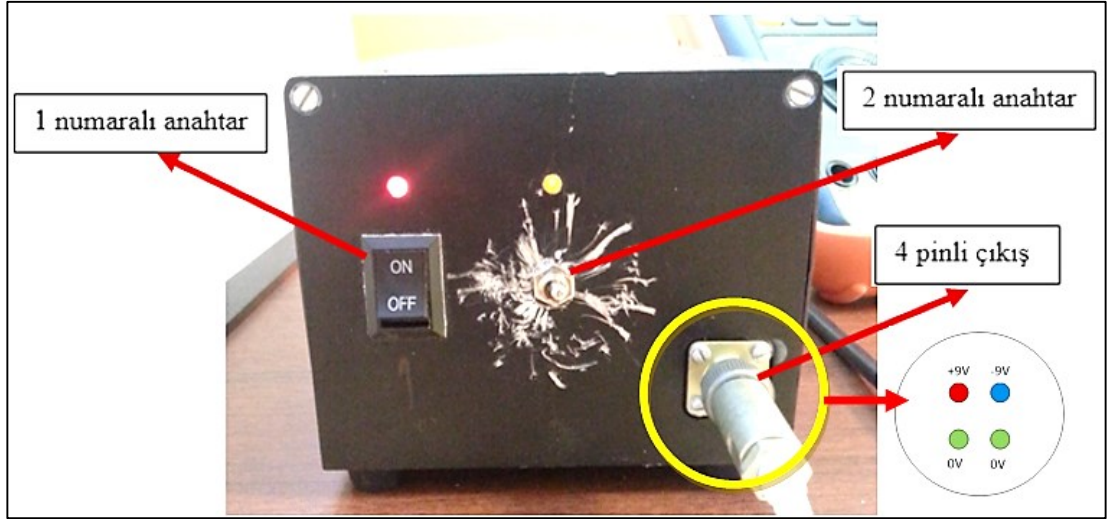
Şekil 6.16. 96 GHz radyometrik alıcının güç kaynağı
