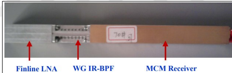
Şekil 5.30. Hem dalga kılavuzu hem de devre içeren radyometrik alıcı
