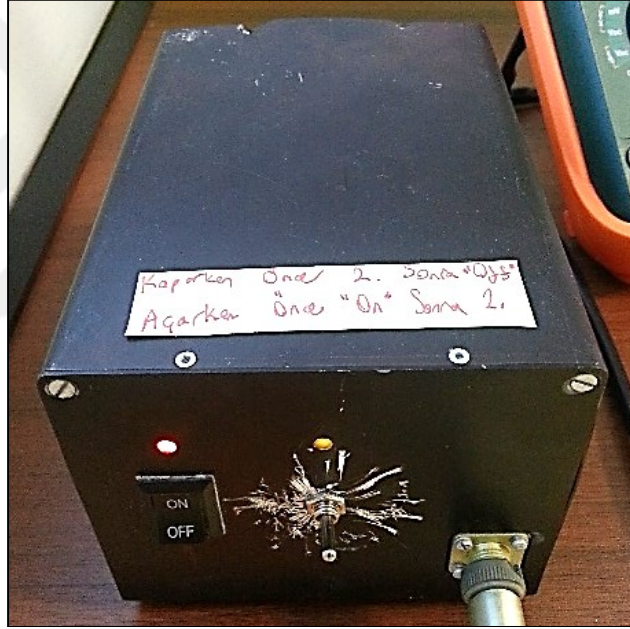
Şekil 6.17. 96 GHz radyometrik alıcının güç kaynağının üstten görünüşü
