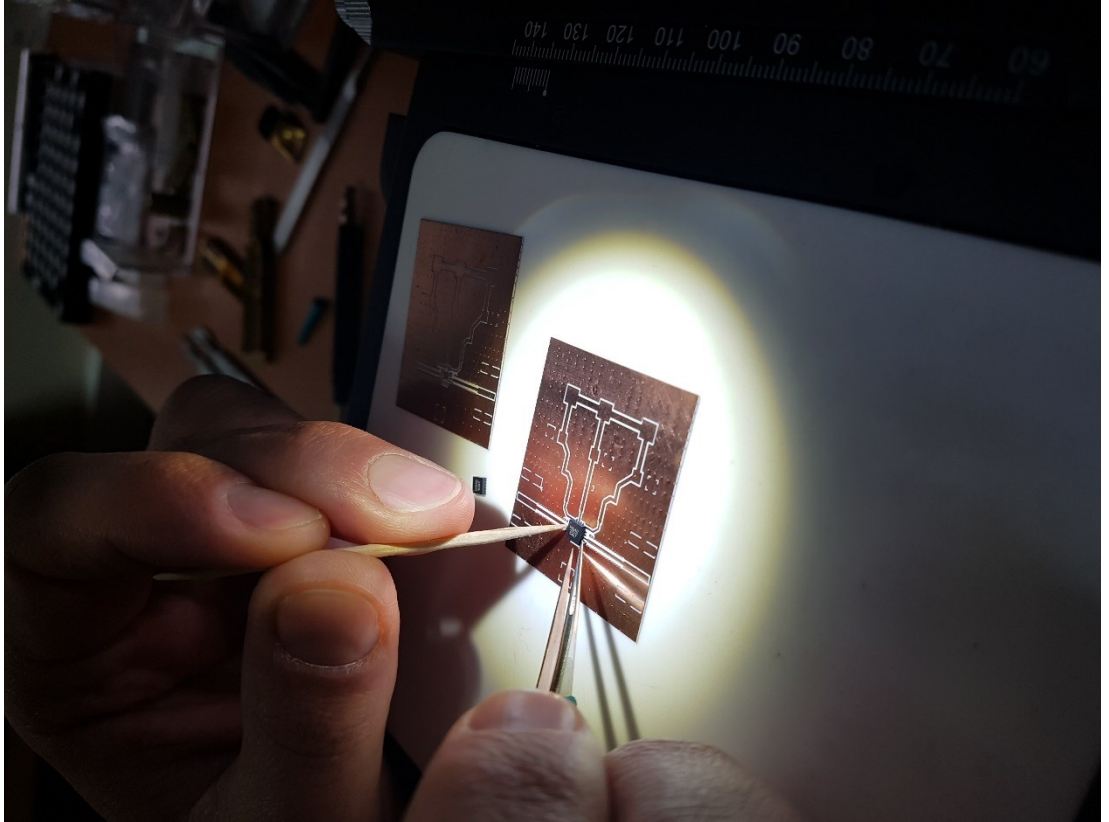
Şekil 8.32. HMC1040LP3CE çipinin entegre edilmesi
