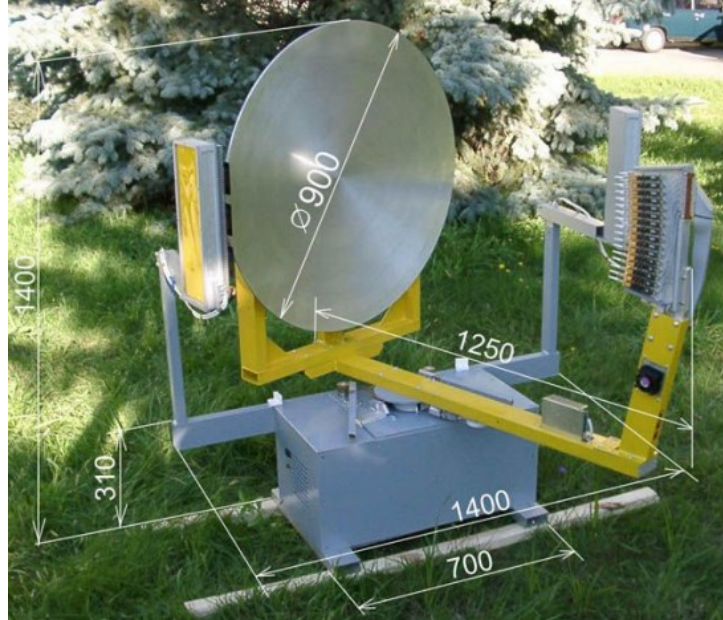
Şekil 5.21. A. Denisov ve ark. pasif milimetre dalga görüntüleme sistemi
