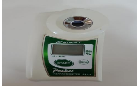
Şekil 2.10. Kiraz meyvelerinde SÇKM ölçümünün yapılışı
