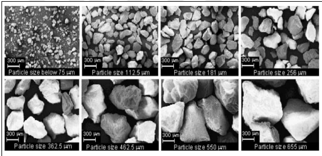
Şekil 3.1. Farklı boyutlarda aşındırıcı partiküllerin SEM görüntüleri [45].
