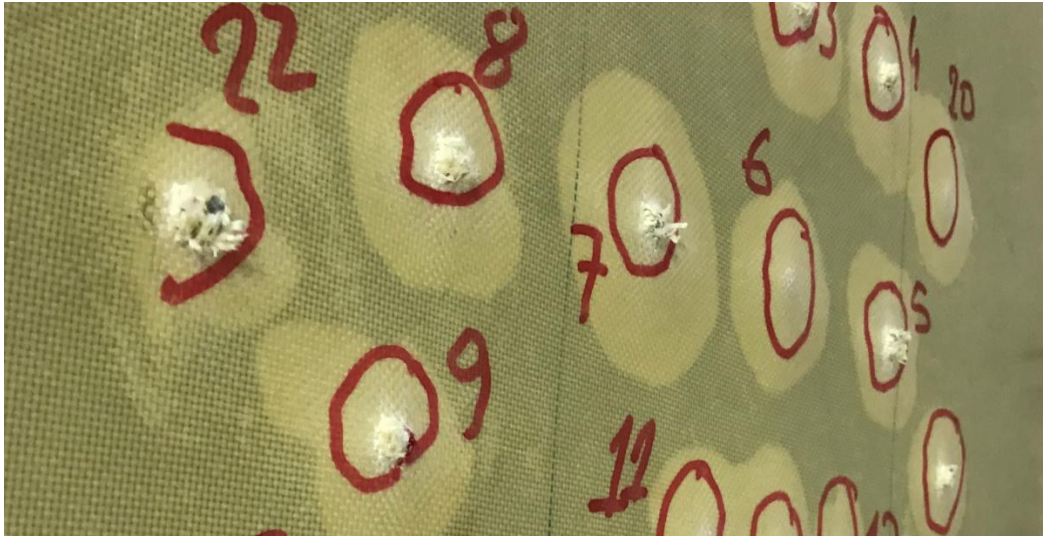
Şekil 4.10. Numune hasar mekanizmaları örnekleri 1
