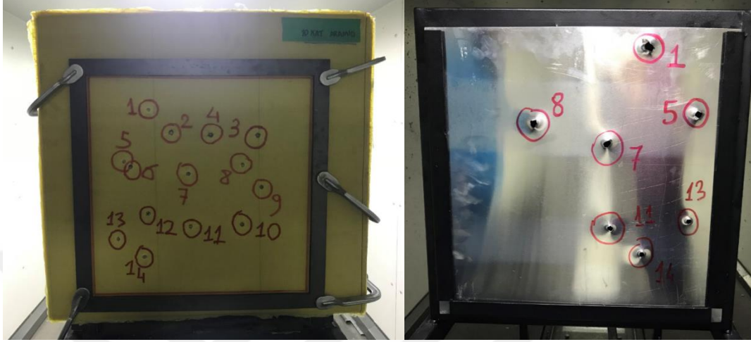
Şekil 4.3. 10 kat aramid tabakalı numune ve şahit plakasının atış sonrası görüntüleri
