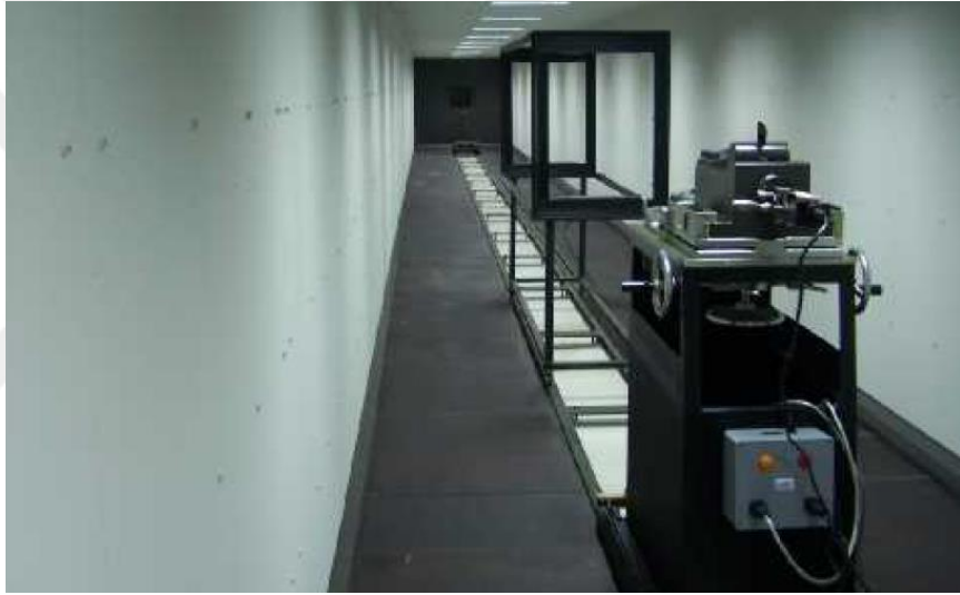
Şekil 3.13. Otokar balistik test laboratuvarı atış ve hız ölçüm sistemi
