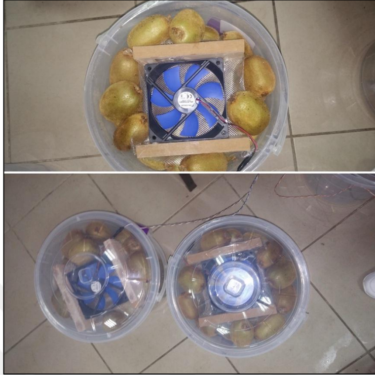
Şekil 2.3.Kimyon yağı uygulamasının yapıldığı hava sirkülasyonlu düzenek
