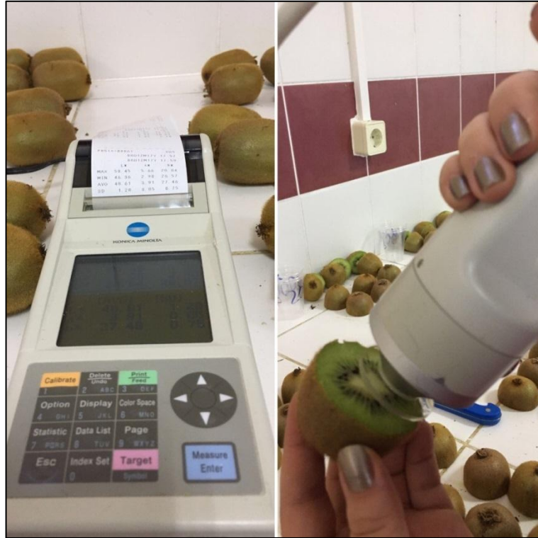
Şekil 2.6.Kivilerde renk ölçüm cihazı ile ve meyve eti rengi ölçümü
