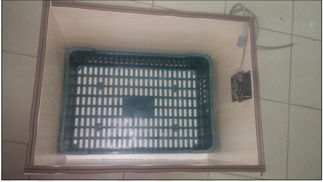
Şekil 2.2.Ozon uygulamasında kullanılan iç sirkülasyonlu sunta kabin
