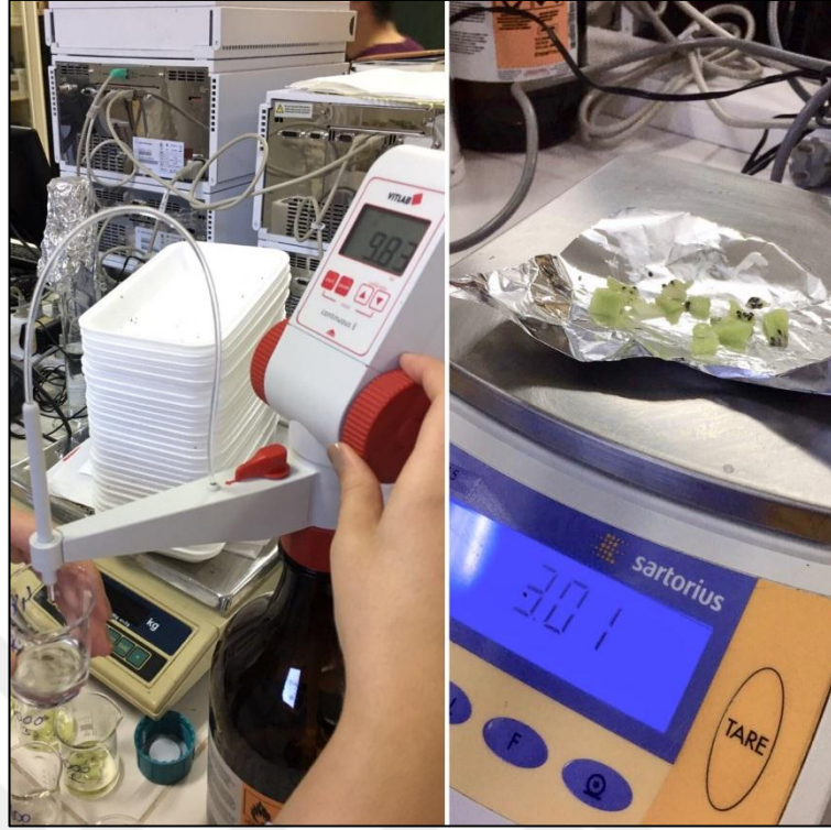
Şekil 2.10.Klorofil ekstraksiyonu (tartım ve aseton ilavesi)
