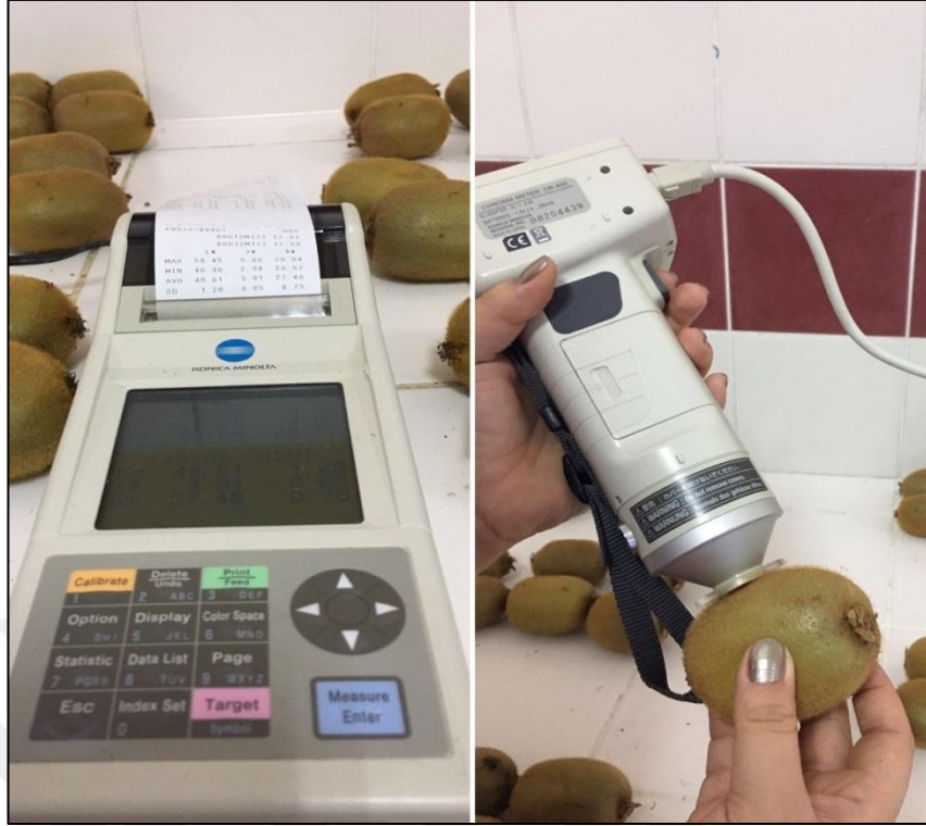
Şekil 2.5.Kivilerde renk ölçümünde kullanılan cihaz ve meyve kabuğu renginin ölçümünün yapılışı
