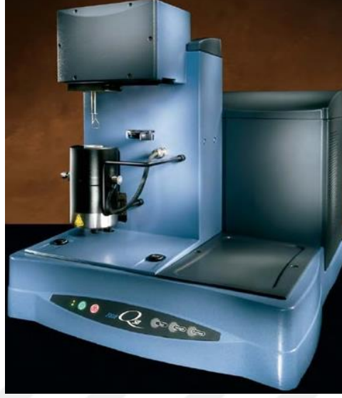
Şekil 3.10. “TA Instruments-Q50” model TGA test cihazı
