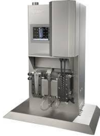
Şekil 3.2. “DSM Xplore” marka mini ekstrüder
