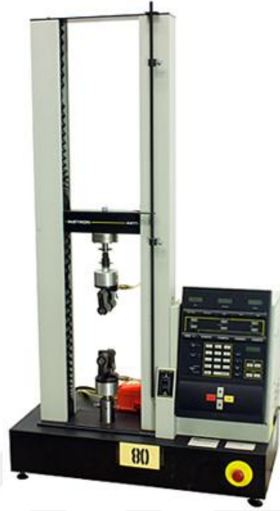
Şekil 3.4. “Instron 4411” marka çekme cihazı
