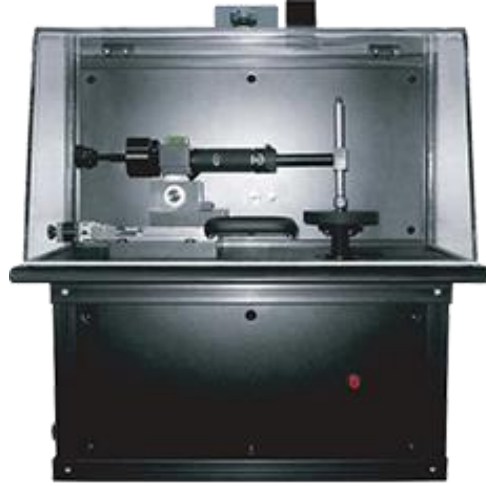
Şekil 3.5. Pin-on-disk test cihazı (Nanovea Tribometer)
