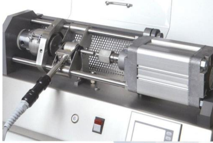
Şekil 3.3. “DSM Xplore” marka enjeksiyonla kalıplama cihazı
