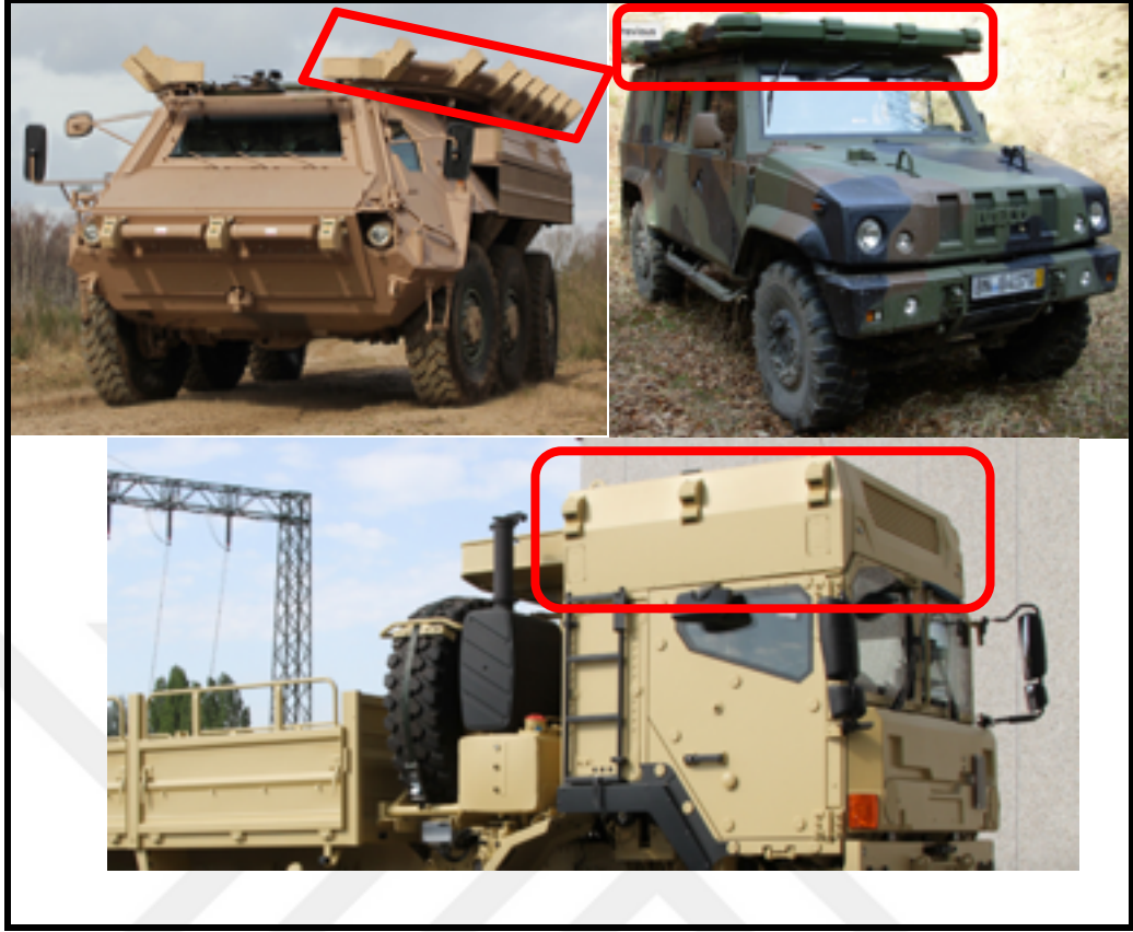
Şekil 1.4. Personel Taşıyıcı ve Kamyonlar İçin Geliştirilen Koruma Sistemleri
