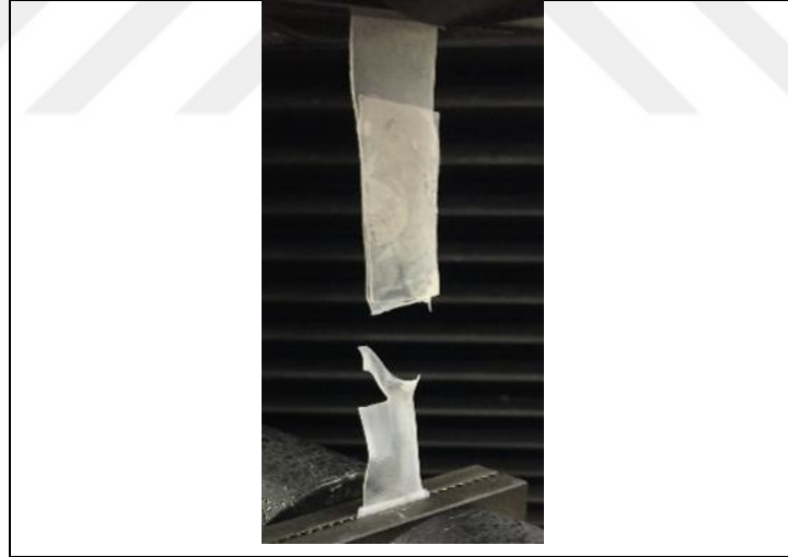
Şekil 4. 3. Suda bekletilmiş PLA/PLA tabakalarının testten sonraki görüntüsü
