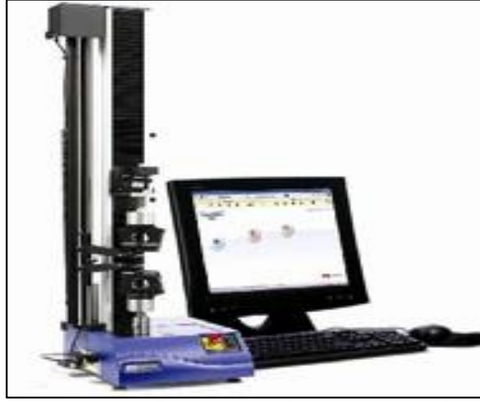
Şekil 3. 3. INSTRON (Model 3345) Çekme Cihazı
