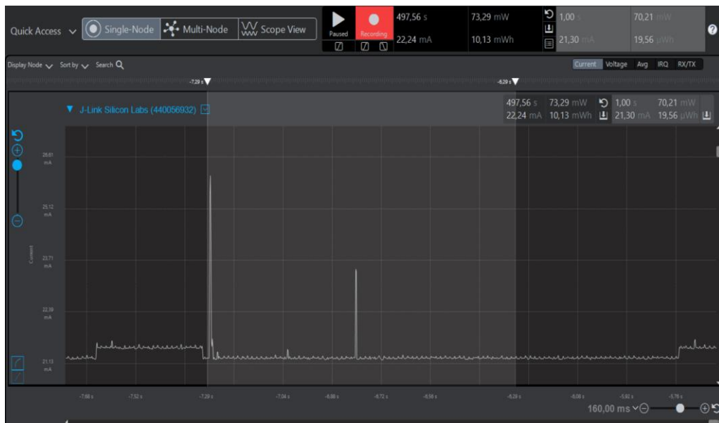
Şekil 4.18. ZigBee, açık alan(10m) mesaj yollama güç ölçümü
