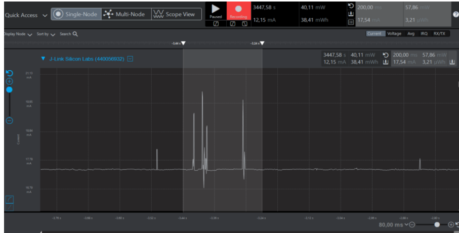
Şekil 4.13. Thread, açık alan(10m) mesaj alma güç ölçümü
