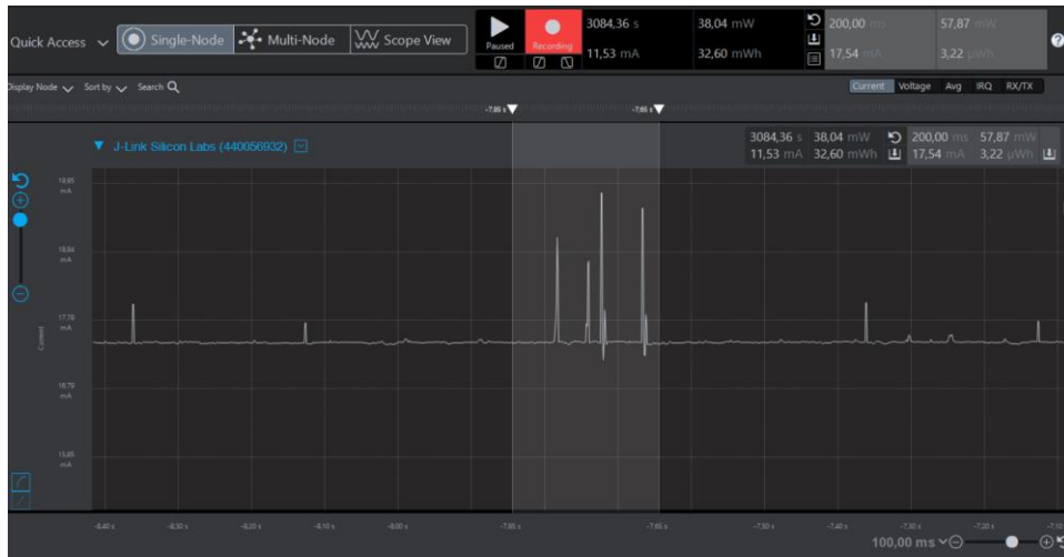
Şekil 4.11. Thread, kapalı alan mesaj alma güç ölçümü
