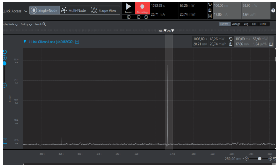
Şekil 4.15. ZigBee, kapalı alan mesaj alma güç ölçümü
