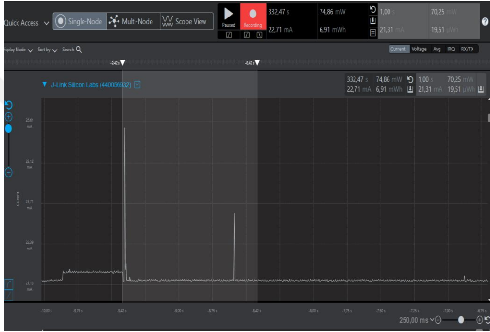
Şekil 4.16. ZigBee, kapalı alan mesaj yollama güç ölçümü
