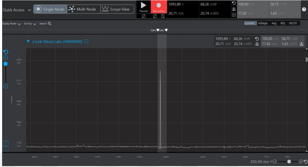
Şekil 4.17. ZigBee, açık alan(10m) mesaj alma güç ölçümü
