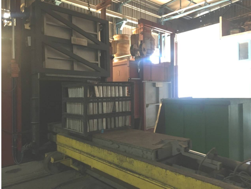
Şekil 5.35. Çözeltiye alma ısıl işlemi
