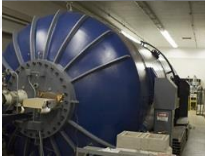
Şekil 4.1. FN Tandem hızlandırıcısının basınç tankı [45]
