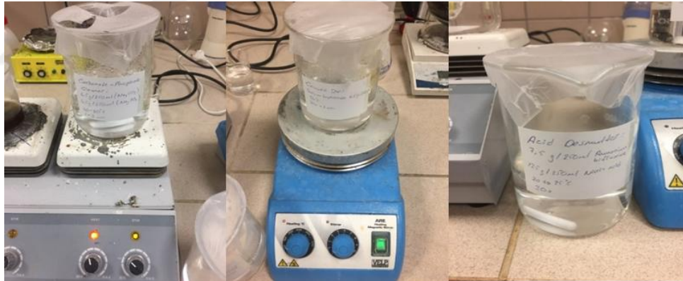
Şekil 5.1. Bakır köpükleri kaplamak için kullanılan ön hazırlık banyoları
