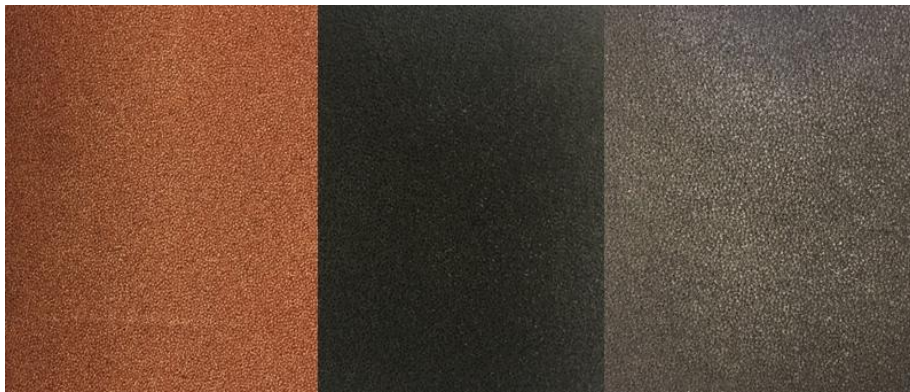
Şekil 5.2. Sırası ile kaplamasız ticari bakır köpük, Pd-Zn ile kaplanmış ticari bakır köpük, Pd ile kaplanmış bakır köpük
