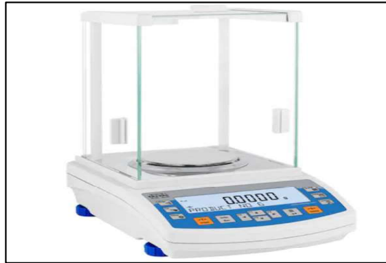
Şekil 5.8. RADWAG AS 220/C/2 hassas analitik terazi.
