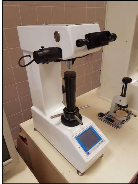
Şekil 5.6. Future-Tech FV-700 vikers sertlik ölçüm cihazı.
