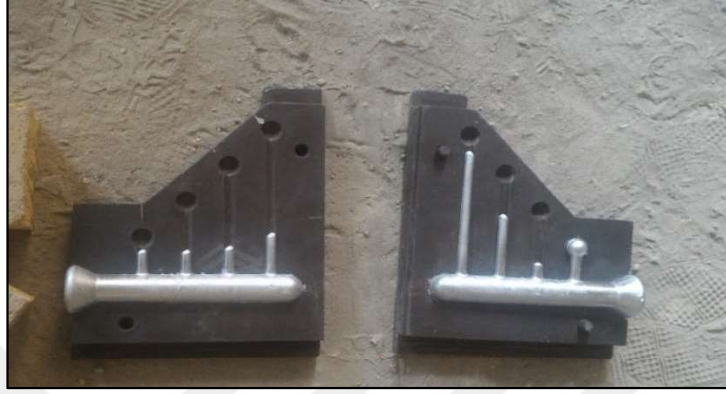
Şekil 6.3. 700°C Sıcak yırtılma testi sonucu.
