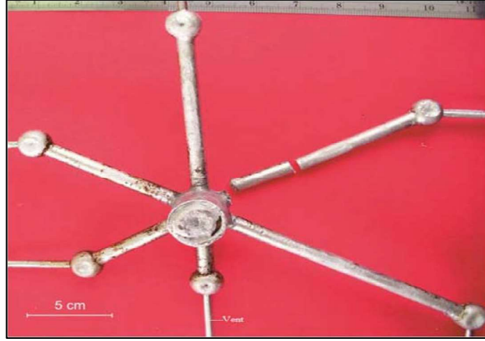
Şekil 4.2. Sıcak yırtılma test numunesi [29].
