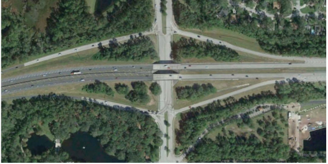
Şekil 1.6. Baklava diamond köprülü kavşak uydu fotoğrafı
